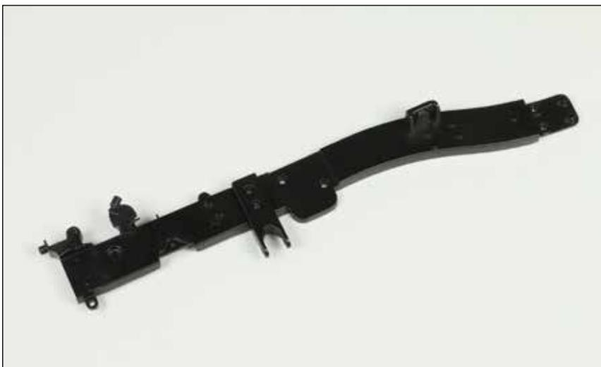
Die Montage des Leiterraumens hat mit dem linken vorderen Längsträger begonnen: eine Windenhalterung, das Gehäuse der Handbremse und ein Querlenkerhalter wurden angebracht.
