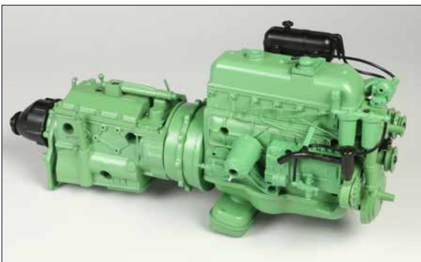
Die Motor-Getriebe-Baugruppe nähert sich ihrer Fertigstellung. Die Lichtmaschine und der Öleinfüllstutzen wurden am Motor angebracht.
