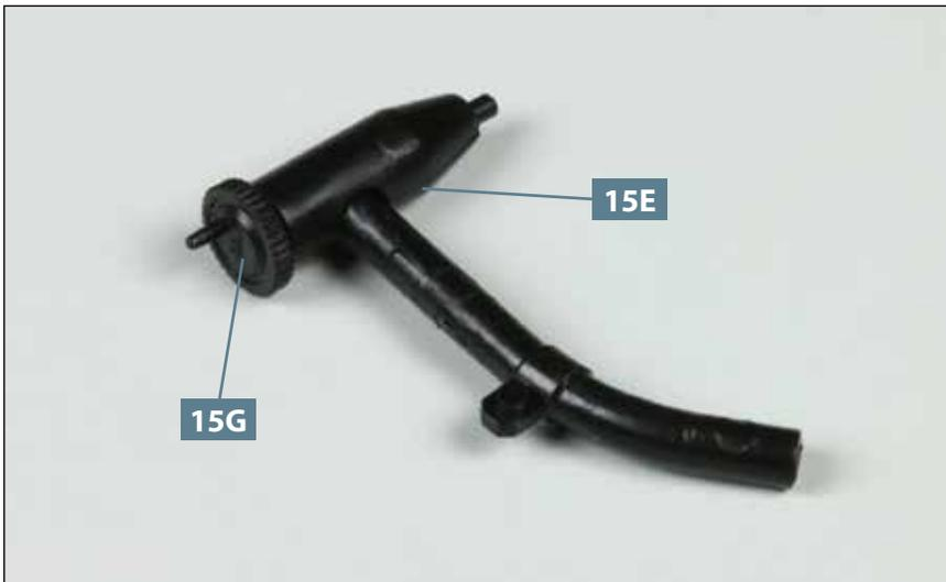
**03** Befestigen Sie den Deckel **15G** am Öleinfüllrohr **15E**: Drücken Sie dazu den kleinen Zapfen an der Unterseite des Deckels vorsichtig in die Bohrung am Teil **15E** hinein.
