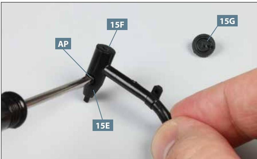
**02** Fixieren Sie den Öleinfüllstutzen **15F** am Öleinfüllrohr **15E**, indem Sie in der Bohrung von **15E** die Schraube **AP** festziehen. Legen Sie den Deckel **15G** bereit.
