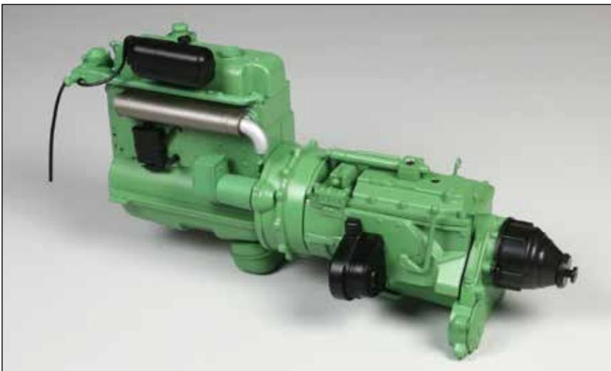
Das Getriebe des Unimog ist komplettiert: Die Rückwand, das Schubkugelgehäuse und eine Schaltkurbel wurden montiert.
