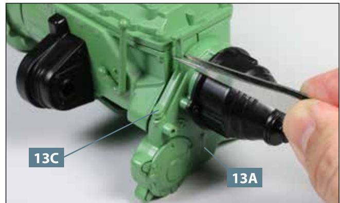
**10** Die Schaltkurbel **13C** wird an der Motor-Getriebe-Baugruppe befestigt, indem Sie ihren Zapfen in die entsprechende Bohrung der Getrieberrückwand **13A** hineindrücken.
