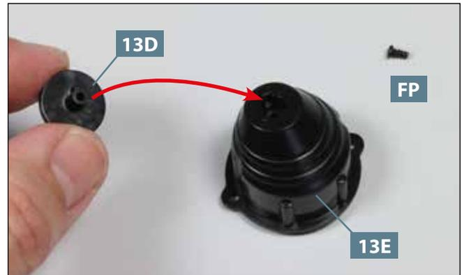
**04** Legen Sie das Schubkugelgehäuse **13E** und eine Schraube **FP** bereit. Nehmen Sie das Endstück **13D** und führen Sie es zur zentralen Bohrung von **13E**, wie angedeutet.
