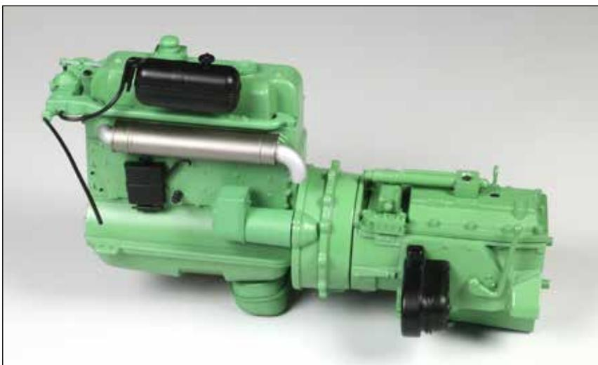
Die Motor-Getriebe-Baugruppe ist abermals gewachsen: Die rechte Getriebehälfte, ein Nebenabtrieb und diverse weitere Bauteile wurden montiert.
