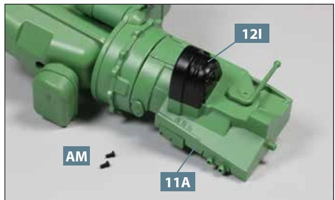
**06** Der Nebenabtrieb **12I** ist korrekt auf der linken Getriebehälfte **11A** platziert. Legen Sie zwei Schrauben **AM** bereit, wie es das Foto zeigt.
