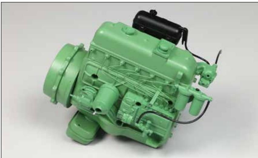
13 Anschlüsse, sechs Druckleitungen, eine Kraftstoffleitung und zwei Kühlwasserleitungen sind am Motor angebracht. Der Kraftstofffilter und eine Halterung wurden montiert.
