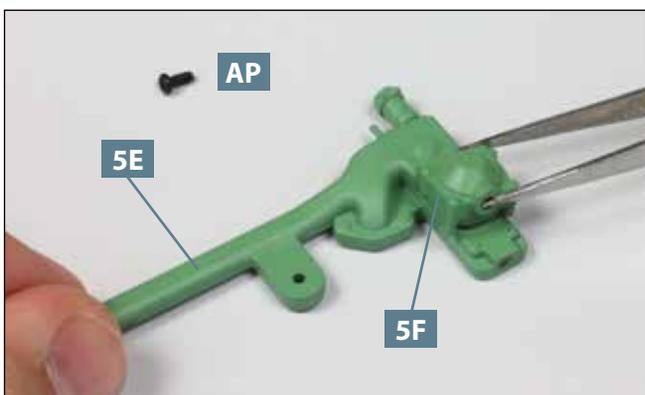
**05** Platzieren Sie das Kühlwasser-Thermostat **5F** über der Bohrung am Ende der Kühlwasser-Sammelleitung **5E**. Legen Sie eine Schraube **AP** bereit.
