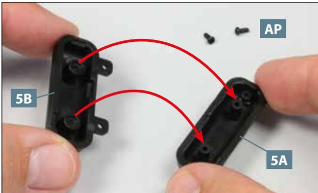
**01** Legen Sie zwei Schrauben **AP** bereit. Nehmen Sie die beiden Hälften des Ausgleichsbehälters, **5A** und **5B**, und fügen Sie sie zusammen, wie angedeutet.
