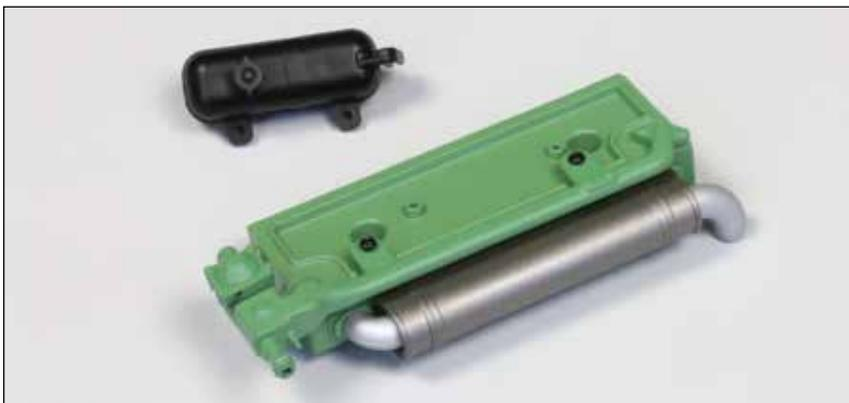
Der Kühlwasser-Ausgleichsbehälter wurde zusammengebaut und mit einem Deckel sowie einem Anschluss-Teil versehen. Am Zylinderkopf wurden der Auspuffkrümmer und die mit dem Thermostat versehene Kühlwasser-Sammelleitung angebracht.
