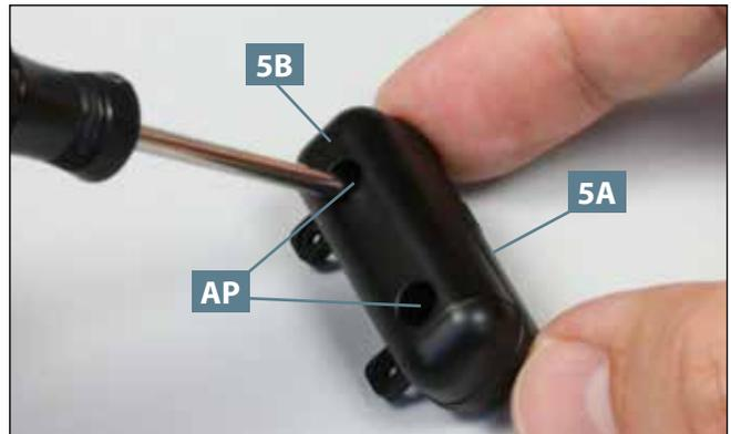
**02** Fixieren Sie die beiden Hälften des Ausgleichsbehälters, **5A** und **5B**, aneinander, indem Sie die beiden Schrauben **AP** in die Bohrungen eindrehen, wie abgebildet.
