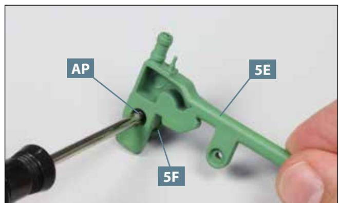
**06** Halten Sie das Thermostat **5F** in Position, während Sie die Sammelleitung **5E** umdrehen. Fixieren Sie beide Teile aneinander, indem Sie die Schraube **AP** eindrehen.
