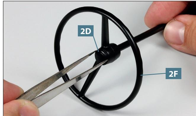
**04** Setzen Sie die Abdeckkappe **2D** auf die Nabe des Lenkrads **2F**, wie es das Foto zeigt.
