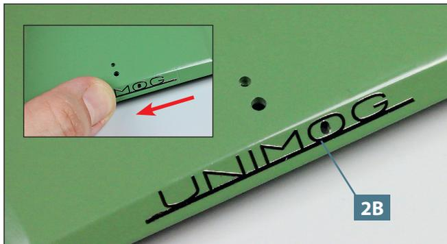
**03** Fahren Sie mehrfach gleichmäßig mit Druck über die gesamte Fläche des Logos (Detailfoto). Entfernen Sie anschließend ganz vorsichtig die Klebefolie vom Logo **2B**.
