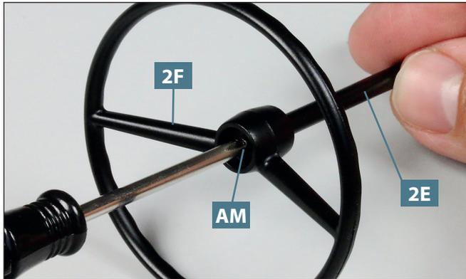
**03** Befestigen Sie die Lenksäule **2E** am Lenkrad **2F**, indem Sie von oben die Schraube **AM** in die Nabe des Lenkrads eindrehen, wie abgebildet.
