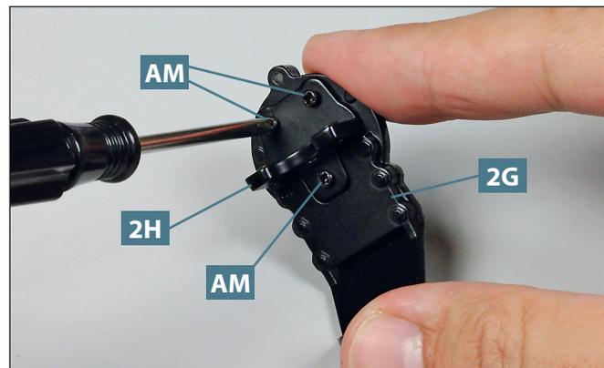
**06** Befestigen Sie die Winkelplatte **2H** mit drei Schrauben **AM** am Achsschenkel **2G**, wie abgebildet.
