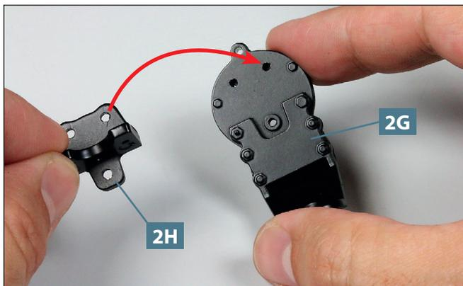
**05** Legen Sie den Achsschenkel **2G** auf Ihre Arbeitsplatte. Nehmen Sie die Winkelplatte **2H** und setzen Sie sie auf den Achsschenkel, wie angedeutet.
