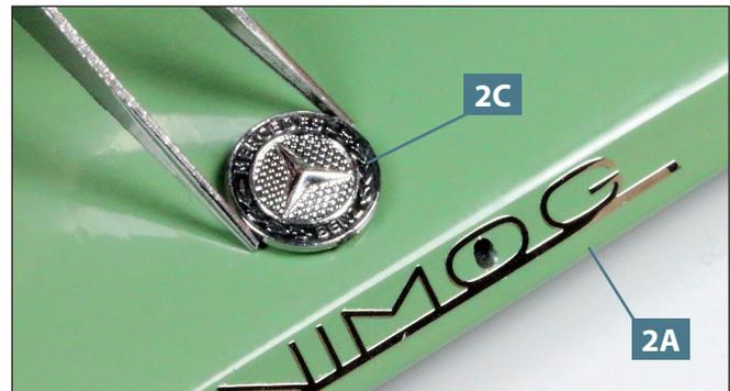
**04** Befestigen Sie das Firmenzeichen **2C** mittig auf der Motorhaube **2A**. Fügen Sie dazu dessen zwei Zapfen in die entsprechenden Bohrungen ein.
