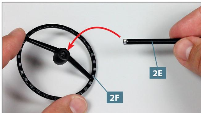
**01** Fügen Sie das abgeflachte Ende der Lenksäule **2E** in die Nabe des Lenkrads **2F** ein, wie angedeutet.
