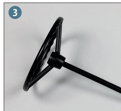
**03** Erst anschließend wird die von Farbe befreite Aufnahme der Lenksäule in die Nabe des Lenkrads eingefügt und verschraubt.
