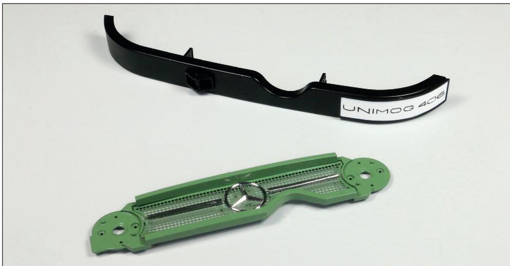
Die beiden bearbeiteten Baugruppen für die Front des Unimog: Der Frontgrill hat den Mercedes-Stern und zwei Zierleisten erhalten; an der Stoßstange wurden das Koppelmaul, das Nummernschild und weitere Teile angebracht.
