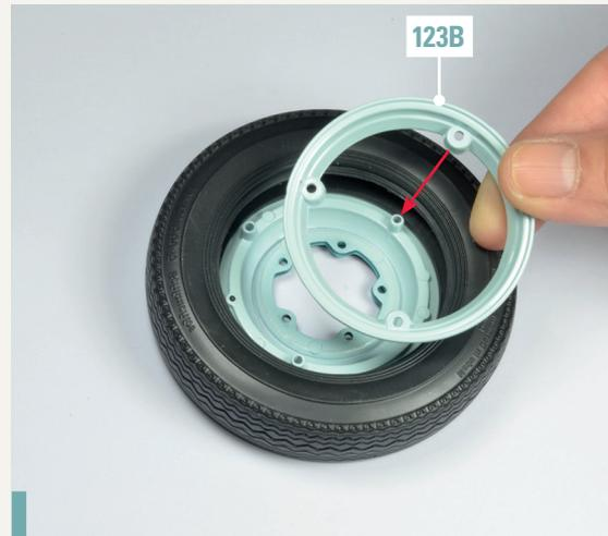
**123-2.** Drehen Sie die Baugruppe um und setzen Sie die Innenfelge 123B in die Innenseite des Reifens.
