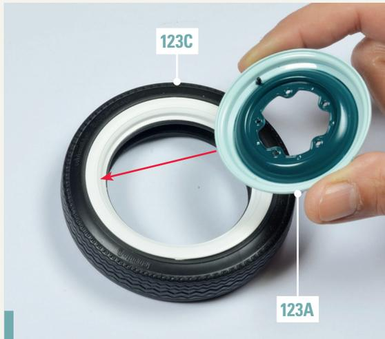
**123-1.** Bringen Sie die Außenfelge 123A an der Außenseite des Reifens 123C an, erkennbar an dem umlaufenden weißen Streifen.
