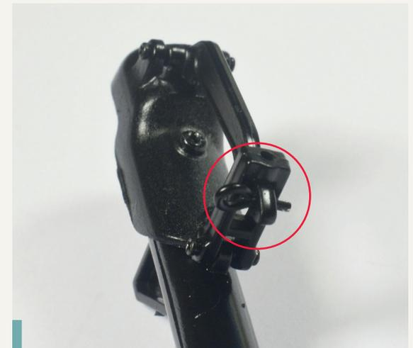
**120-9.** Sobald der Bolzen in das Loch eingeführt ist, verhindert er, dass der Hebel aus dem Bügelbolzen gleitet.
