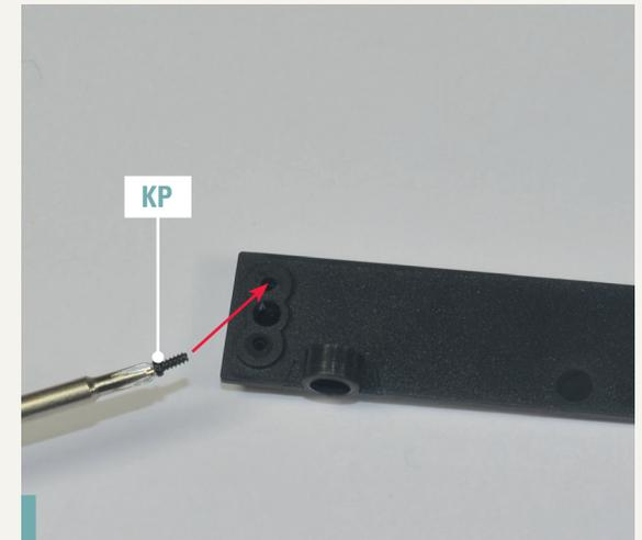
**118-3.** Beginnen Sie auf der Rückseite des Kennzeichens mit der Befestigung der Leuchte, indem Sie eine Schraube KP in der angegebenen Bohrung anziehen.
