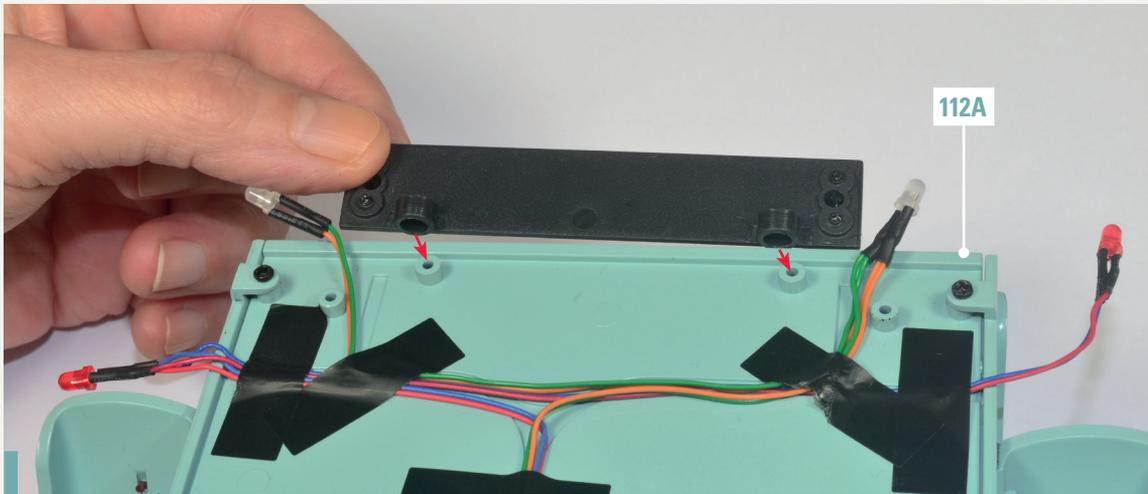
**118-7.** Nehmen Sie Ihren Anhänger zur Hand. Legen Sie ihn umgedreht auf Ihre Arbeitsfläche und montieren Sie das Kennzeichen an der vorgesehenen Position auf dem vorderen Profil der Bodenplatte 112A. Richten Sie die Komponenten dazu wie abgebildet aus und stecken Sie die beiden Ösen des Kennzeichens in die gelochten Stifte der Bodenplatte.
