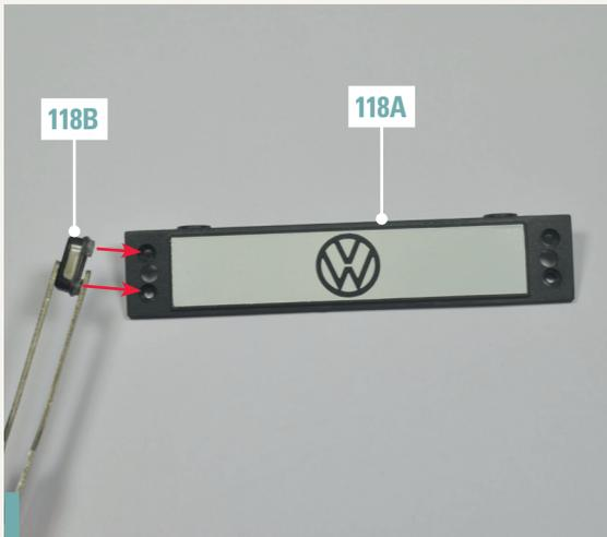
**118-1.** Setzen Sie eine der Kennzeichenleuchten 118B in eine der Aussparungen an der Außenseite des Kennzeichens 118A. Richten Sie die Teile wie abgebildet aus: Die Leuchtenfolie muss nach innen zeigen.
