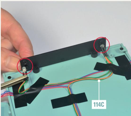
**118-9.** Stecken Sie die beiden LEDs des Kabels 114C (orange und grün) in die entsprechenden Löcher an der Innenseite des Kennzeichens, die sich bei den beiden Leuchten befinden.
