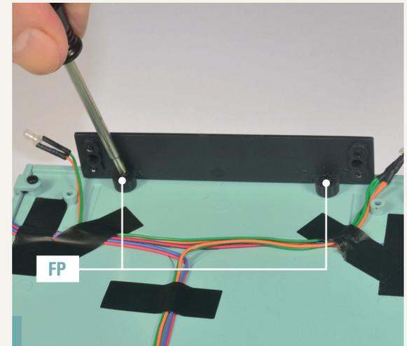
**118-8.** Befestigen Sie das Kennzeichen mit zwei Schrauben FP.
