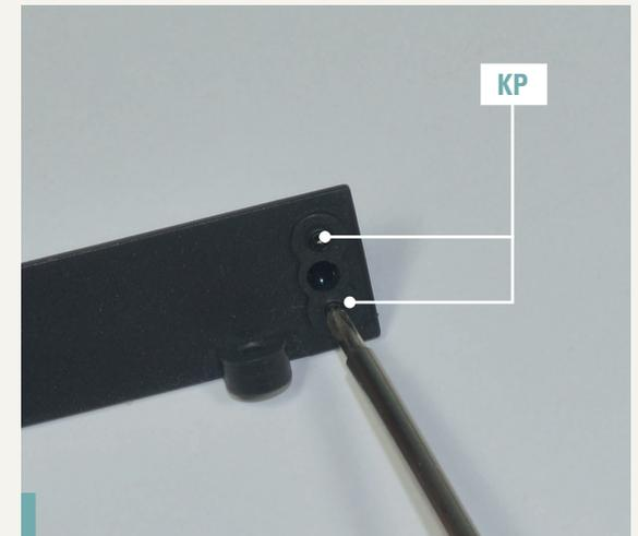
**118-6.** Befestigen Sie die Leuchte, indem Sie zwei Schrauben KP von der Rückseite in den angegebenen Löchern anziehen.
