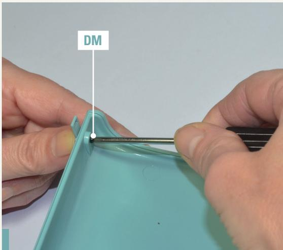
**117-9.** Sichern Sie das zweite Scharnier mit einer weiteren Schraube DM an der Haube.
