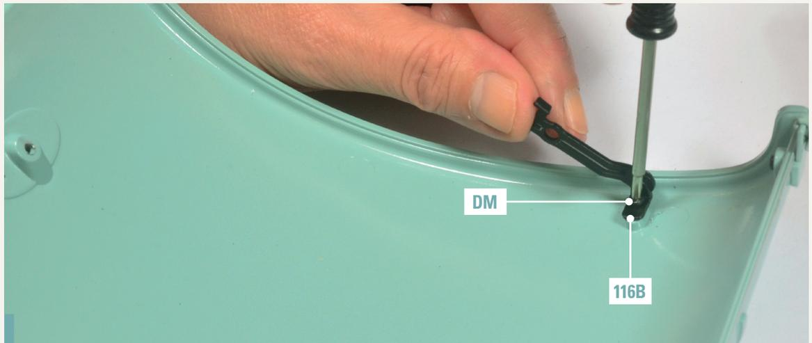
**117-10.** Nehmen Sie den Hebel 2 zur Hand, den Sie in Ausgabe 116 zusammengebaut haben. Setzen Sie die Halterung 116B in die entsprechende Position auf der Innenseite der Haube neben die Scharniere. Richten Sie die Teile wie abgebildet aus und befestigen Sie sie mit einer Schraube DM.
