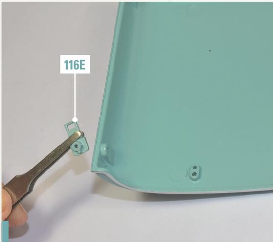
**117-6.** Nehmen Sie nun die beiden Scharniere 116E zur Hand, die Sie ebenfalls mit Ausgabe 116 erhalten haben. Setzen Sie einen davon in eine der Vertiefungen am vorderen Profil der Haube ein. Die Teile können nur in eine Richtung ausgerichtet werden.
