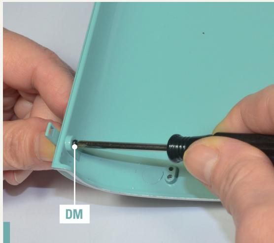
**117-7.** Befestigen Sie das Scharnier mit einer Schraube DM an der Haube.
