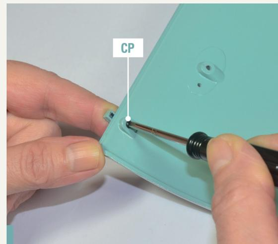
**117-3.** Befestigen Sie den Griff von der Innenseite der Haube mit einer Schraube CP.
