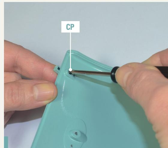
**117-5.** Ziehen Sie eine Schraube CP von innen in dem auf dem Foto gezeigten Loch an, um den Griff an der Haube zu befestigen.
