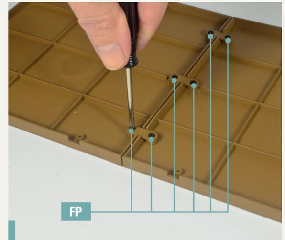
**103-3.** Ziehen Sie sechs Schrauben FP (zwei pro Verbindung) in den angezeigten Löchern fest.
