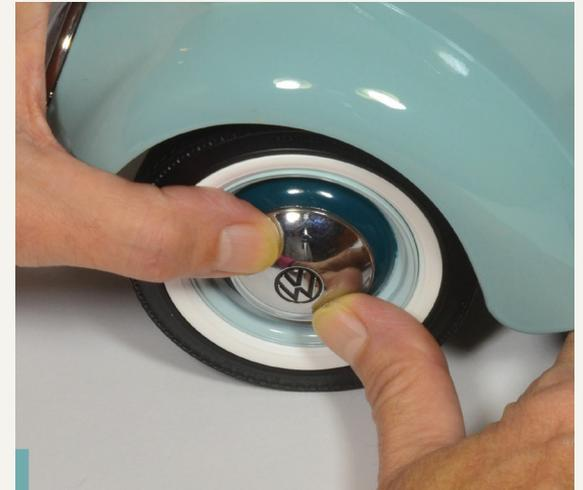
**97-2.** Üben Sie leichten Druck auf die gesamte Fläche der Radkappe aus, um sie am Rad zu befestigen.
