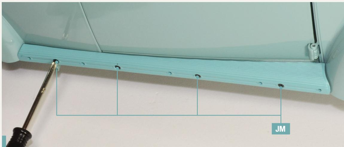
**95-2.** Setzen Sie je eine Schraube JM in die vier gezeigten Löcher ein und ziehen Sie sie schrittweise fest, bis das Trittbrett perfekt an der Karosserie befestigt ist.
