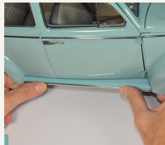
**95-4.** Üben Sie leichten Druck aus, um die Zierleiste zu befestigen.
