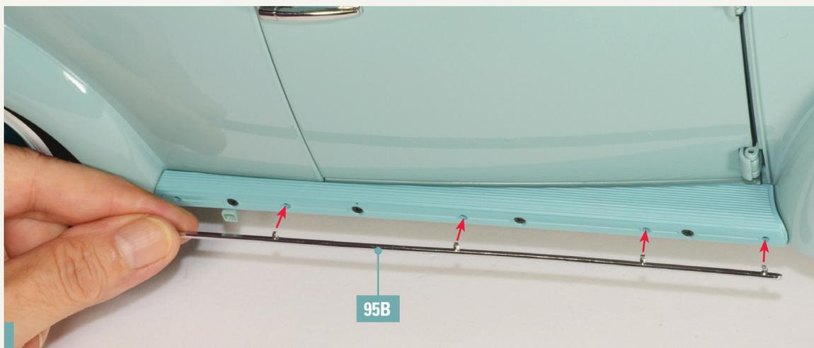
**95-3.** Montieren Sie die Zierleiste 95B an das rechte Trittbrett, indem Sie die Stifte der Zierleiste in die Löcher des Trittbretts einführen.
