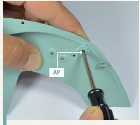
**87-4.** Befestigen Sie die Halterung, indem Sie eine Schraube AP im angezeigten Loch auf der gegenüberliegenden Seite der Baugruppe festziehen.
