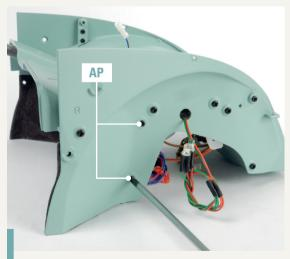
**87-7.** Schließen Sie die Befestigung ab, indem Sie zwei Schrauben AP in den gezeigten Löchern festziehen.
