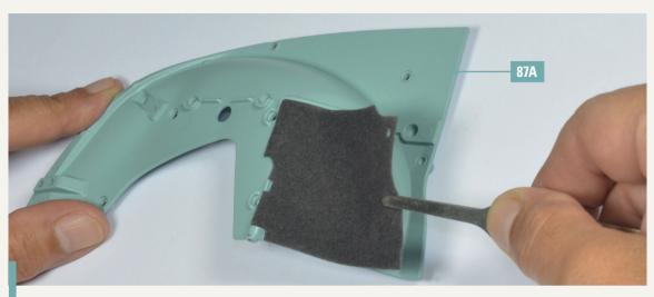
87-2. Befestigen Sie den Teppich an der entsprechenden Stelle auf der Innenseite des rechten vorderen Kotflügels 87A, indem Sie die Komponenten wie auf dem Foto gezeigt ausrichten.
