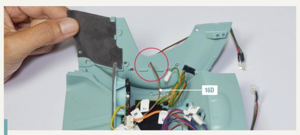
87-5. Nehmen Sie die Gepäckwanne zur Hand und legen Sie sie auf Ihre Arbeitsfläche neben das Innenteil des vorderen rechten Kotflügels, wobei Sie die Teile wie abgebildet ausrichten. Führen Sie die beiden LEDs des Kabelbaums 16D (Kennzeichnung "8"), die sich auf der linken Seite der Platine befinden, durch das entsprechende Loch im inneren Teil des Kotflügels (roter Kreis).
