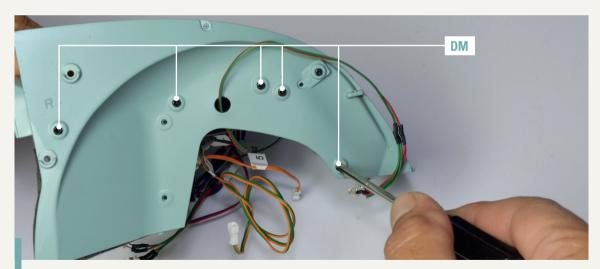
87-6. Beginnen Sie mit der Befestigung des Kotflügelinnenteils am Rest der Baugruppe, indem Sie fünf Schrauben DM in den gezeigten Löchern festziehen.
