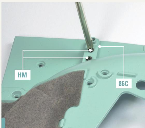
**86-3.** Bringen Sie die Halterung 86C in der auf dem Foto gezeigten Position an und befestigen Sie sie mit zwei Schrauben HM.
