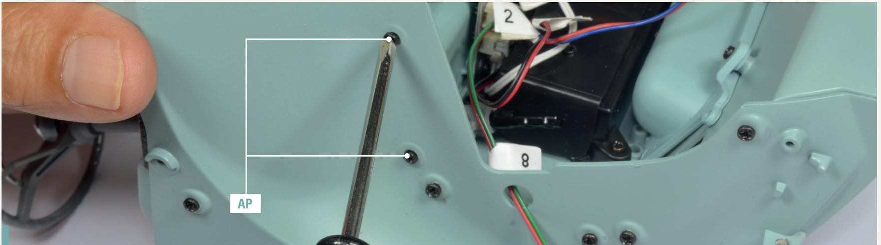
**86-6.** Schließen Sie die Befestigung des inneren Kotflügels ab, indem Sie zwei Schrauben AP in den gezeigten Löchern festziehen.
