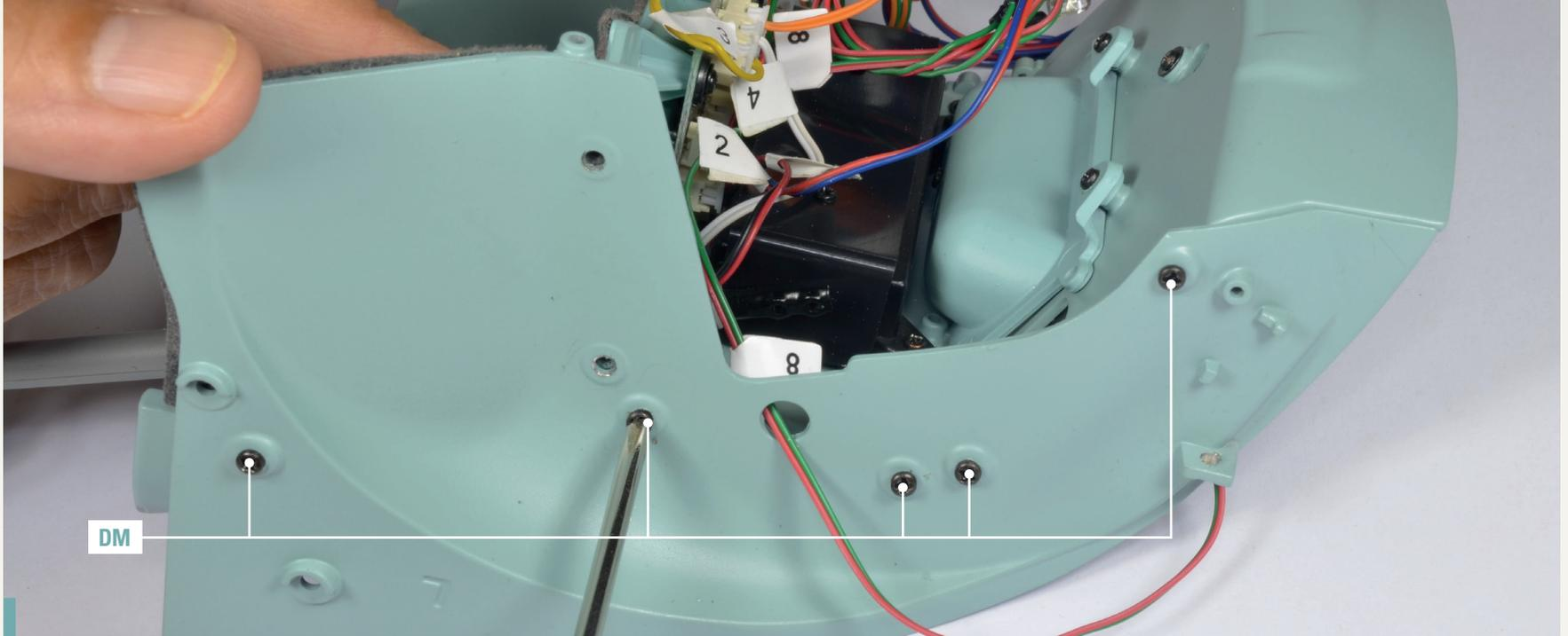
**86-5.** Befestigen Sie das Innenteil des Kotflügels am Profil der Gepäckwanne und an der vorderen Trennwand des Fahrgastraums, indem Sie fünf Schrauben DM in den auf dem Foto angegebenen Löchern festziehen.
