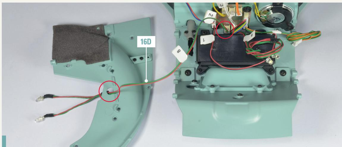
**86-4.** Nehmen Sie die Gepäckwanne zur Hand und legen Sie sie auf Ihre Arbeitsfläche neben das Innenteil des vorderen linken Kotflügels, wobei Sie die Teile wie abgebildet ausrichten. Führen Sie die beiden LEDs des Kabelbaums 16D (Kennzeichnung „8“), die sich auf der linken Seite der Platine befinden, durch das entsprechende Loch vom inneren Teil des Kotflügels (rot eingekreist).
