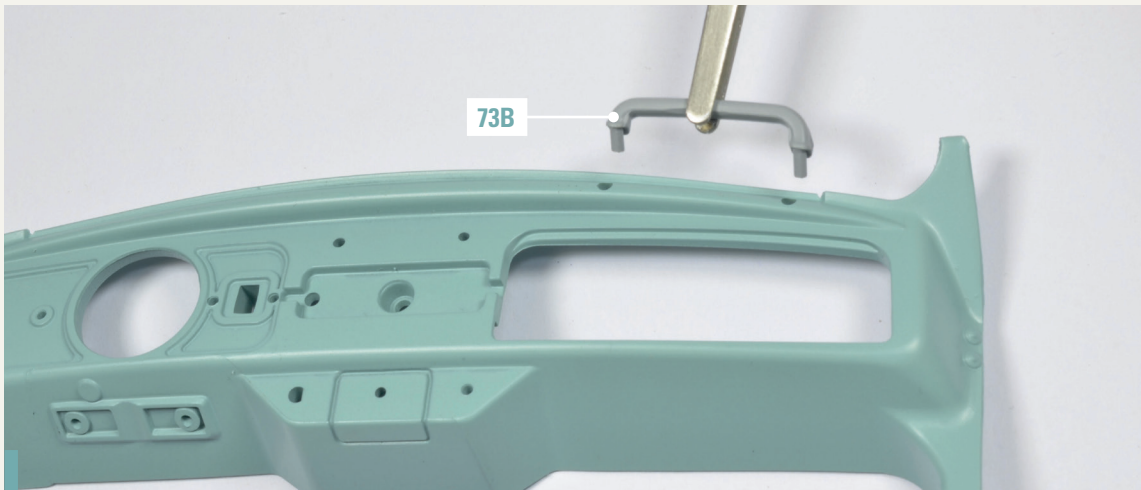
73-8. Montieren Sie an der Außenseite der Struktur den Beifahrer-Haltegriff 73B in den Löchern über dem Staufach. Orientieren Sie sich am Foto, um ihn korrekt auszurichten.
