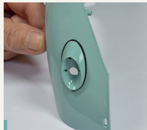
66-4. So sieht das Gehäuse nach der Montage am linken hinteren Kotflügel aus.
