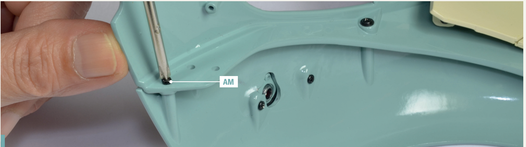
66-12. Ziehen Sie dann eine Schraube AM in dem auf dem Foto markierten Loch fest.
