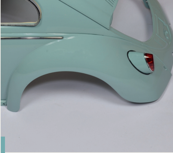
66-10. So sieht der korrekt montierte hintere linke Kotflügel aus.
