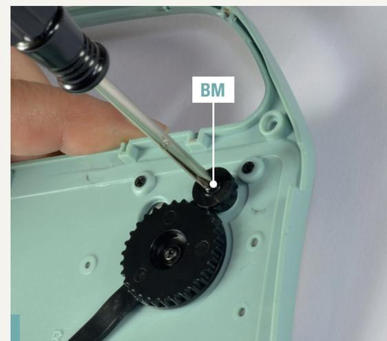
**58-6.** Befestigen Sie die Teile mit einer Schraube BM.
