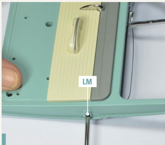
**58-13.** Schließen Sie die Befestigung der beiden Türteile ab, indem Sie eine weitere Schraube LM in dem auf dem Foto gezeigten Loch festziehen.
