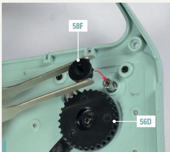
**58-5.** Setzen Sie das Ritzel 58F von hinten auf den Stift der Fensterkurbel. Richten Sie die Teile wie auf dem Foto gezeigt aus. Fensterkurbel und Fensterheber 56D werden auf diese Weise miteinander verbunden.
