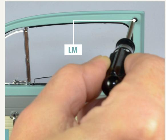
**58-12.** Ziehen Sie eine Schraube LM in dem auf dem Foto angegebenen Loch in der oberen Ecke des inneren Teils der Tür fest.
