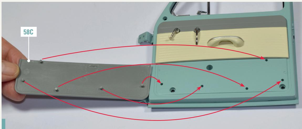
**58-14.** Positionieren Sie die untere Verkleidung 58C auf der Baugruppe. Üben Sie leichten Druck aus, um die Teile miteinander zu verbinden.
