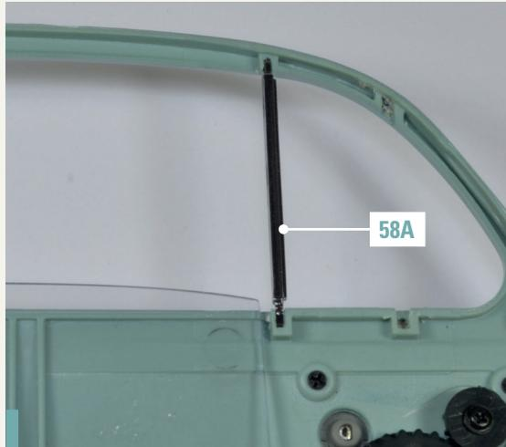
**58-8.** Setzen Sie die Fensterführung 58A in die entsprechenden Schlitz, wie auf dem Foto gezeigt.
