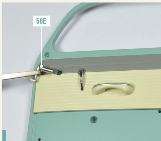
**58-4.** Stecken Sie die Fensterkurbel 58E in das zweite Loch der Verkleidung.
