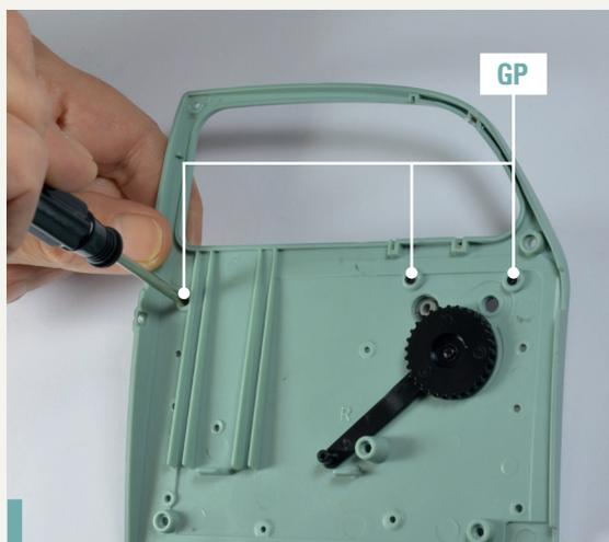
**58-2.** Befestigen Sie die Verkleidung von hinten mit drei Schrauben GP.
