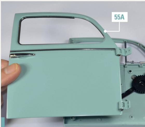
**58-10.** Nehmen Sie den äußeren Teil der Tür 55A zur Hand und verbinden Sie ihn mit dem inneren Teil. Orientieren Sie sich an dem Fotos, um beide Teile richtig auszurichten.
