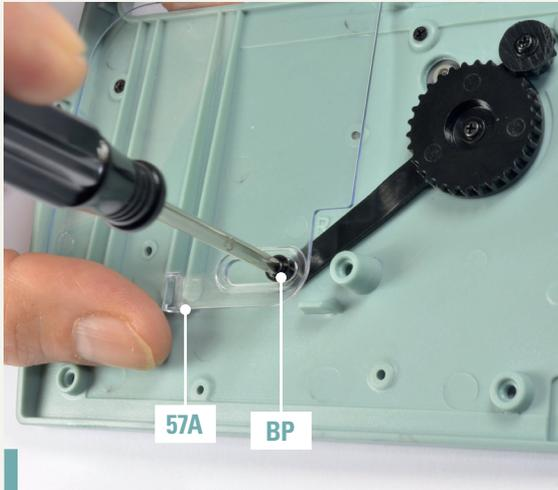
**58-7.** Positionieren Sie die Fensterscheibe 57A wie auf dem Foto gezeigt. Befestigen Sie den Stift des Fensterhebers in der ovalen Aussparung mit einer Schraube BP.
