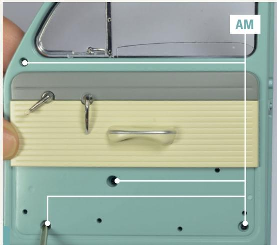
**58-11.** Verbinden Sie die beiden Türteile miteinander, indem Sie vier Schrauben AM in den angezeigten Löchern anziehen.
