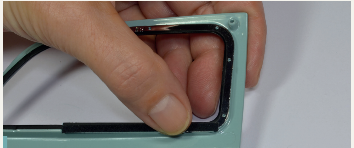
57-8. Legen Sie die Klebeseite der Dichtung auf den Rahmen des Fensters, wie auf dem Foto gezeigt.
