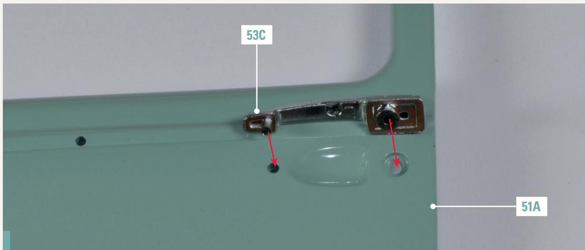
**53-1.** Nehmen Sie den äußeren Teil der linken Tür 51A zur Hand und positionieren Sie den Türgriff 53C so, wie im Foto durch die Pfeile angedeutet.
