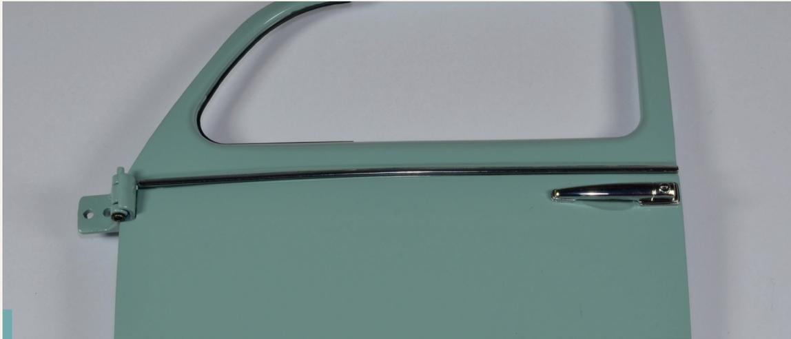
**53-5.** So sieht die korrekt montierte Zierleiste aus.
