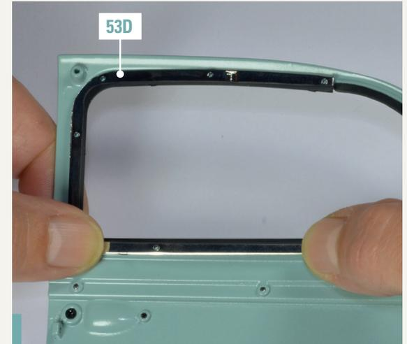
**53-6.** Arbeiten Sie nun an der Innenseite der Tür und montieren Sie den Rahmen 53D in der auf dem Foto gezeigten Position. Üben Sie einen leichten Druck entlang der gesamten Oberfläche aus, um ihn an der Tür zu fixieren.
