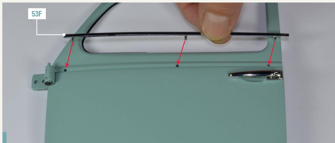
**53-4.** Montieren Sie die Zierleiste 53F in der Türnut, indem Sie die Stifte der Leiste in die auf dem Foto gekennzeichneten Löcher stecken.
