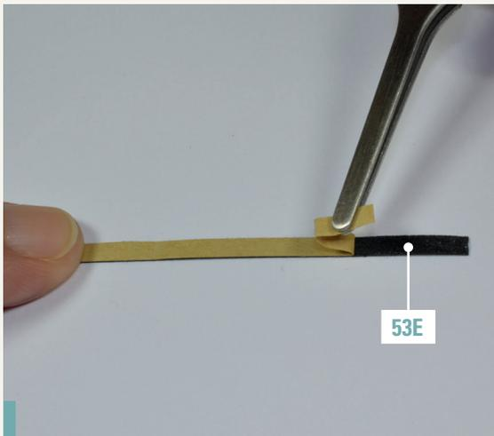
**53-7.** Entfernen Sie die Schutzfolie von der Dichtung 53E.
