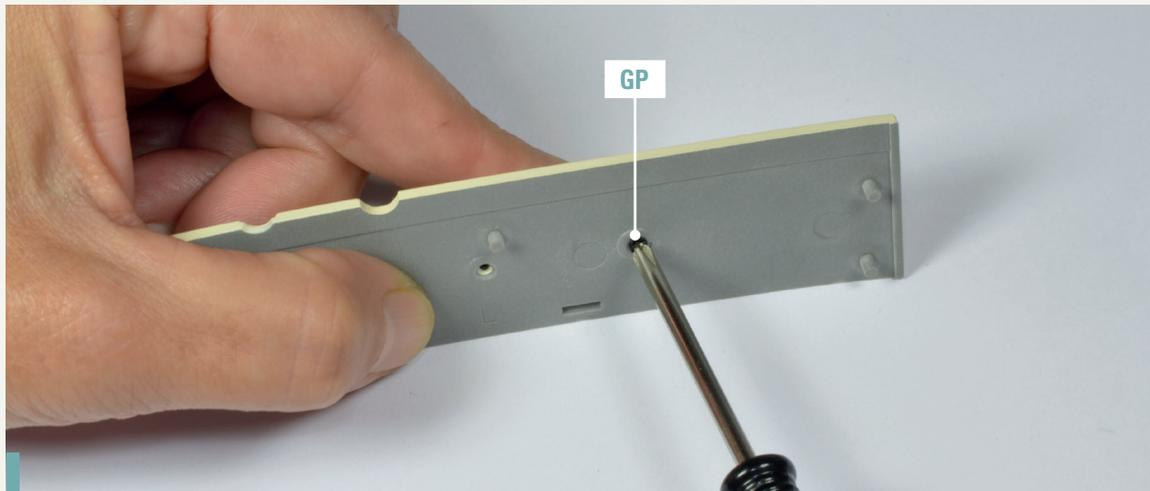
**52-3.** Befestigen Sie die Armlehne mit einer Schraube GP von der hinteren Seite der Verkleidung.
