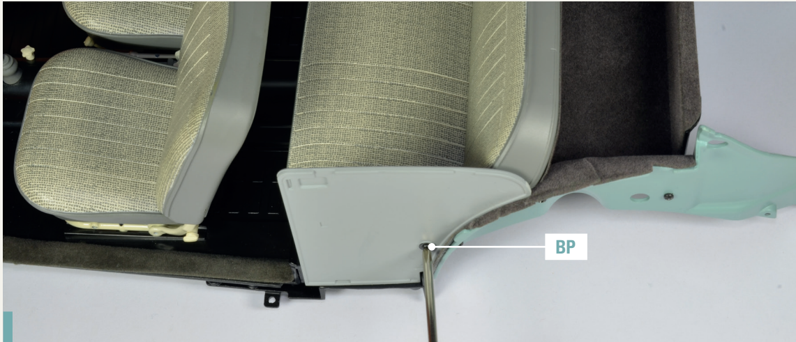
50-5. Befestigen Sie die Rückenlehne mit einer Schraube BP an der linken Innenverkleidung. Ziehen Sie sie nicht bis zum Anschlag fest.
