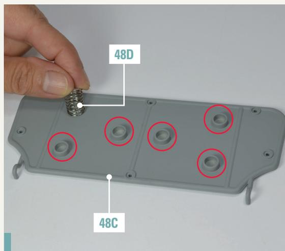
**48-3.** Stecken Sie die sechs Federn 48D in die entsprechenden runden Verbindungsstücke auf der Oberseite des Sitzes 48C.
