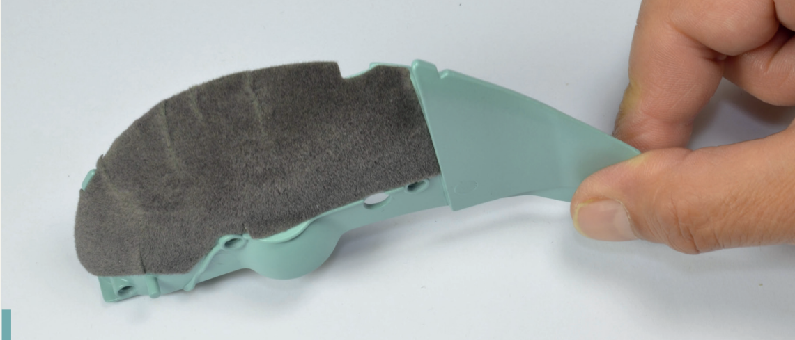
43-6. Vergleichen Sie anhand des Fotos, ob Sie den Teppich des rechten Kotflügels richtig angebracht haben.
