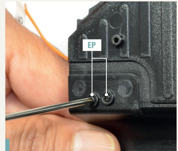
**41-12.** Befestigen Sie alles mit zwei Schrauben EP von der Unterseite des Bodenblechs.
