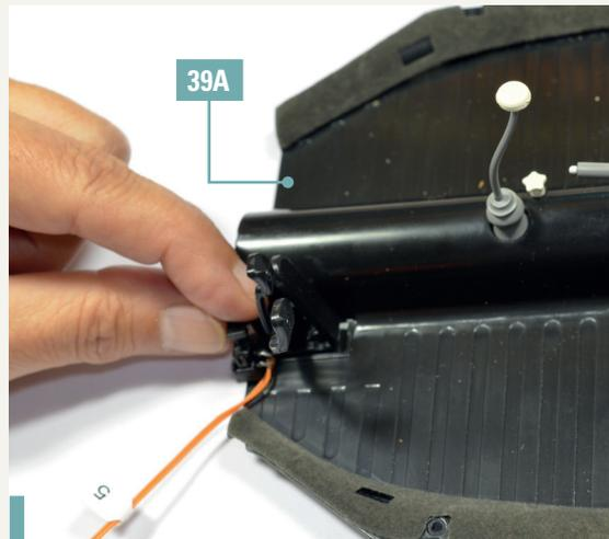
**41-11.** Nehmen Sie das Vorderteil des Bodenblechs 39A zur Hand und montieren Sie die Pedaleinheit an der entsprechenden Stelle.
