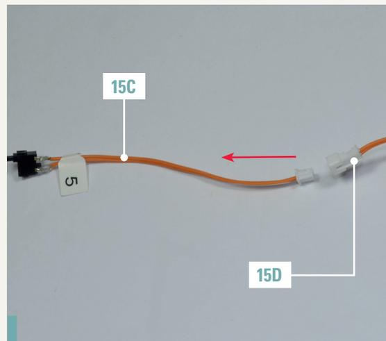
**41-5.** Nehmen Sie die Schaltgruppe Ihres Modells zur Hand und trennen Sie den Kabelbaum 15C vom Kabelbaum 15D (beide sind mit der Ziffer „5“ gekennzeichnet). Achten Sie darauf, die Stifte nicht zu beschädigen.
