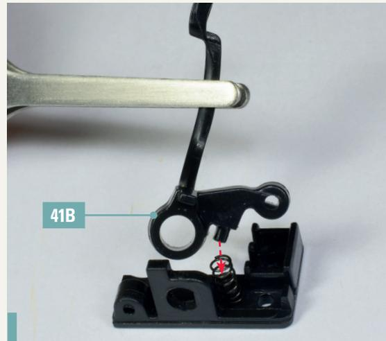
**41-2.** Verbinden Sie auch das Bremspedal 41B mit der Basis, indem Sie es wie gezeigt ausrichten. Stecken Sie den Pedalstift in das freie Ende der Feder.
