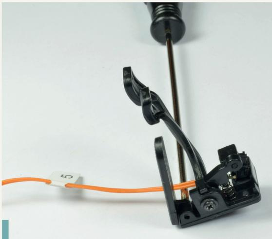
**41-10.** Befestigen Sie das Gaspedal an der Basis und ziehen Sie die Schraube EP fest.
