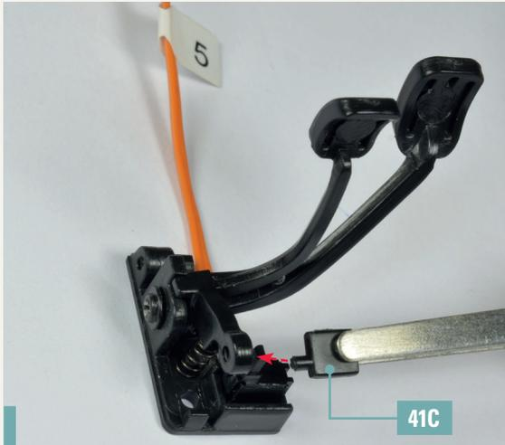
**41-7.** Befestigen Sie auch den Schalter 41C an der Baugruppe: Richten Sie ihn wie abgebildet aus und stecken Sie seinen Stift in das entsprechende Loch im Bremspedal. Durch die Form des Stifts kann der Schalter 41C nur in eine Richtung eingedrückt werden.
