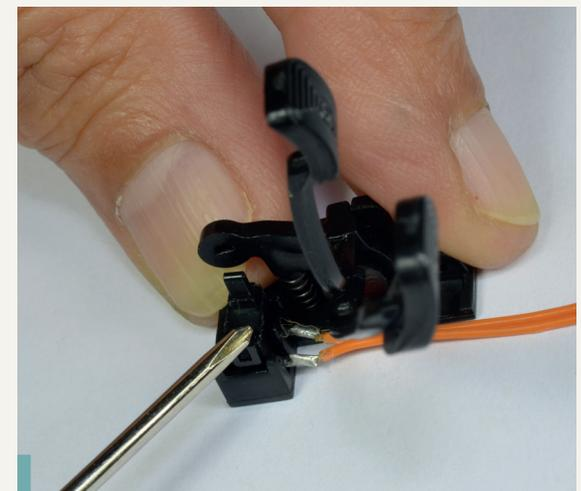
**41-6.** Führen Sie den Schalter des Kabelbaums 15C in den entsprechenden Schlitz der Pedalbasis. Achten Sie darauf, dass die Kabel im rechten Winkel aus der Basis herauslaufen und der Schalter bis zum Anschlag eingedrückt wird. Falls nötig, üben Sie sanften Druck aus.
