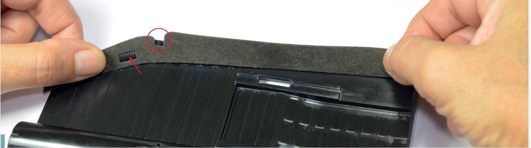
**39-7.** Bringen Sie den Teppich in der auf dem Foto gezeigten Position rechts auf der Vorderseite des Bodenblechs an. Achten Sie auch hier auf die korrekte Position des Teppichs an den Elementen, die durch den Pfeil und den Kreis auf dem Foto gekennzeichnet sind.
