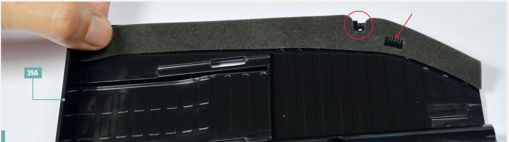
**39-4.** Bringen Sie den Teppich links auf der Vorderseite des Bodenblechs 39A an und richten Sie ihn wie abgebildet aus. Orientieren Sie sich an der Form des Bodenblechs und achten Sie auf die korrekte Position der durch den Kreis und den Pfeil auf dem Foto gekennzeichneten Elemente.
