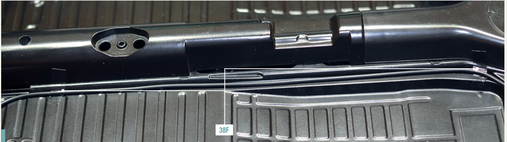
38-8. Befestigen Sie das 290 mm Kabel mithilfe der Klebestreifen 38F am Zentralrohr.
