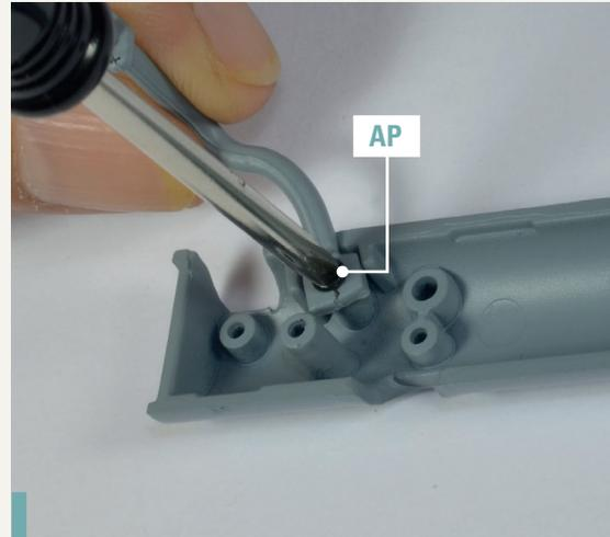
**35-2.** Verbinden Sie die Teile mit einer Schraube AP. Ziehen Sie diese noch nicht vollständig fest.
