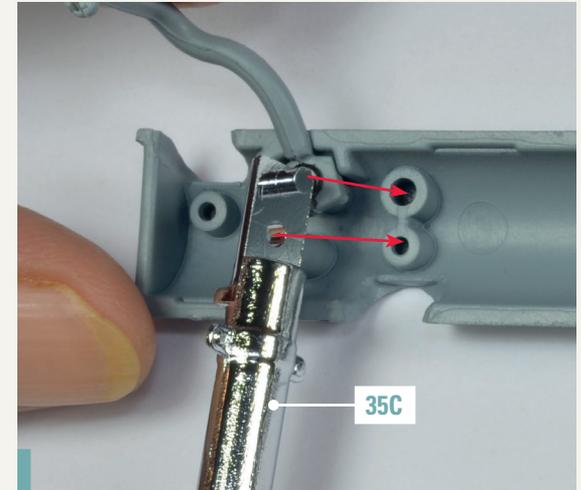
**35-3.** Montieren Sie eines der Endrohre 35C an der entsprechenden Stelle im unteren Teil des Auspufftopfs.
