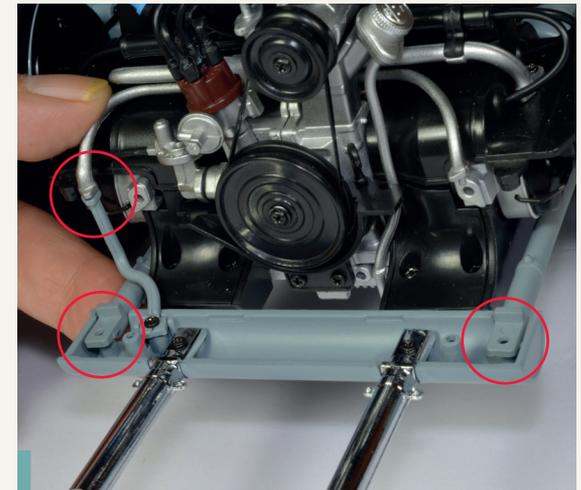
**35-6.** Nehmen Sie das Fahrgestell Ihres Modells zur Hand und montieren Sie den unteren Teil des Auspufftopfs in der im Bild gezeigten Position. Achten Sie auf die korrekte Ausrichtung der durch die Kreise markierten Elemente.
