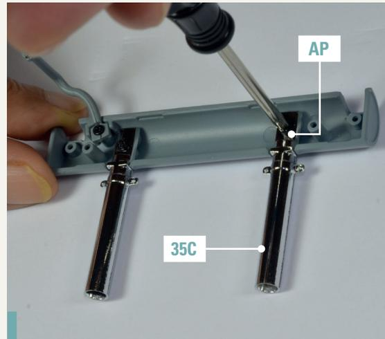
**35-5.** Führen Sie die gleichen Schritte am anderen Ende des Auspufftopfs durch, um auch das zweite Endrohr 35C zu montieren. Befestigen Sie es mit einer weiteren Schraube AP.
