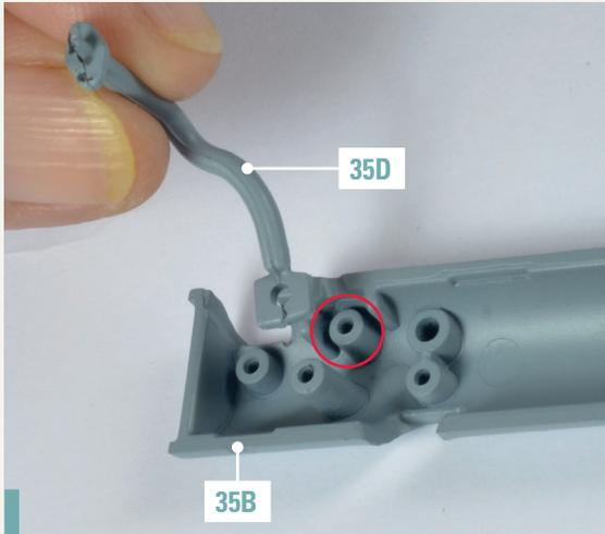
**35-1.** Montieren Sie die Verbindung 1 (35D) an dem durch den Kreis markierten Loch der Säule des unteren Teils des Auspufftopfs 35B. Richten Sie die Teile wie abgebildet aus.
