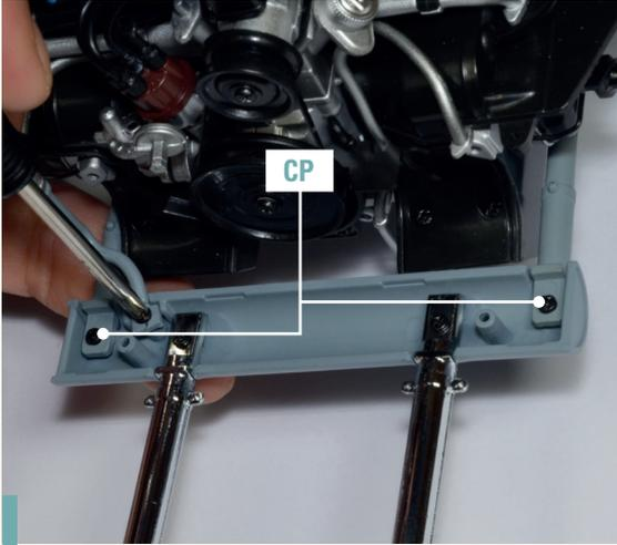
**35-7.** Ziehen Sie zwei Schrauben CP in den angezeigten Löchern fest, um die Komponenten miteinander zu verbinden. Jetzt können Sie die in Schritt 35-2 verwendete Schraube AP vollständig festziehen.
