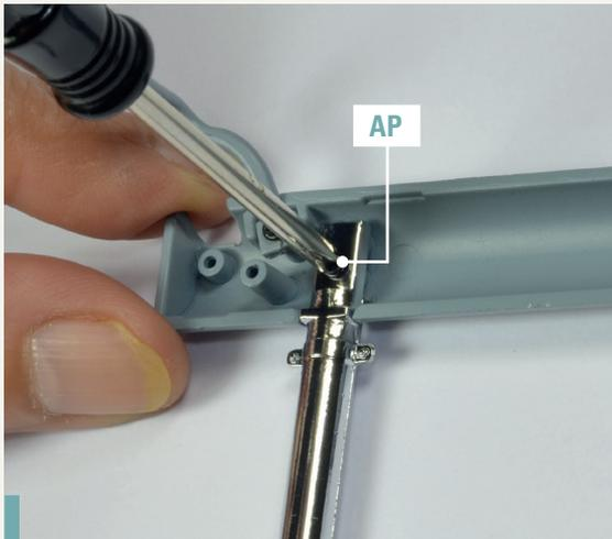
**35-4.** Verwenden Sie eine Schraube AP, um das Endrohr zu befestigen.
