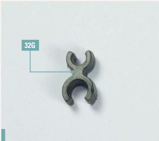
32-5. Die Befestigungsclips 32G haben zwei Öffnungen: eine kleinere (zur Verbindung mit dem Saugrohr) und eine größere (zur Fixierung der Kabel).
