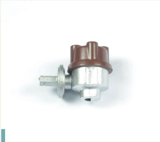
**31-6.** Prüfen Sie anhand der Abbildung, ob Sie den Zündverteiler korrekt zusammengesetzt haben.
