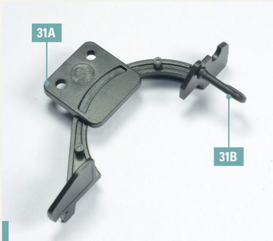
**31-1.** Stecken Sie den Ölpeilstab 31B auf das entsprechende Ende der Motorhalterung 31A. Richten Sie die Teile wie auf dem Foto gezeigt aus.
