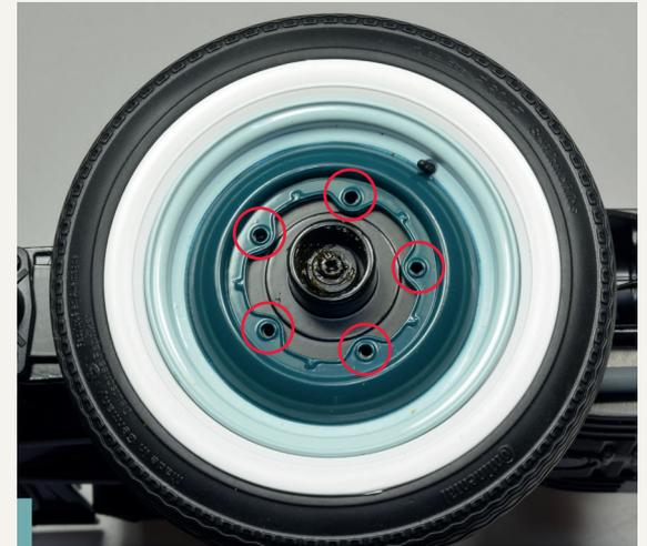
**27-7.** Drehen Sie das Rad, bis die fünf Löcher der Außenfelge und der Außenteil der Trommelbremse, die in der Abbildung durch die roten Kreise gekennzeichnet sind, aufeinander ausgerichtet sind.
