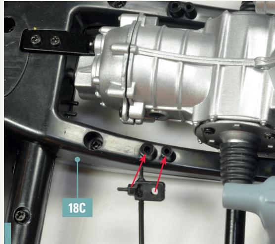
**23-2.** Nehmen Sie die Fahrgestell-Baugruppe Ihres Modells und montieren Sie den Anschluss in der vorgesehenen Position auf der linken Seite des Fahrgestell-Mittelträgers 18C.
