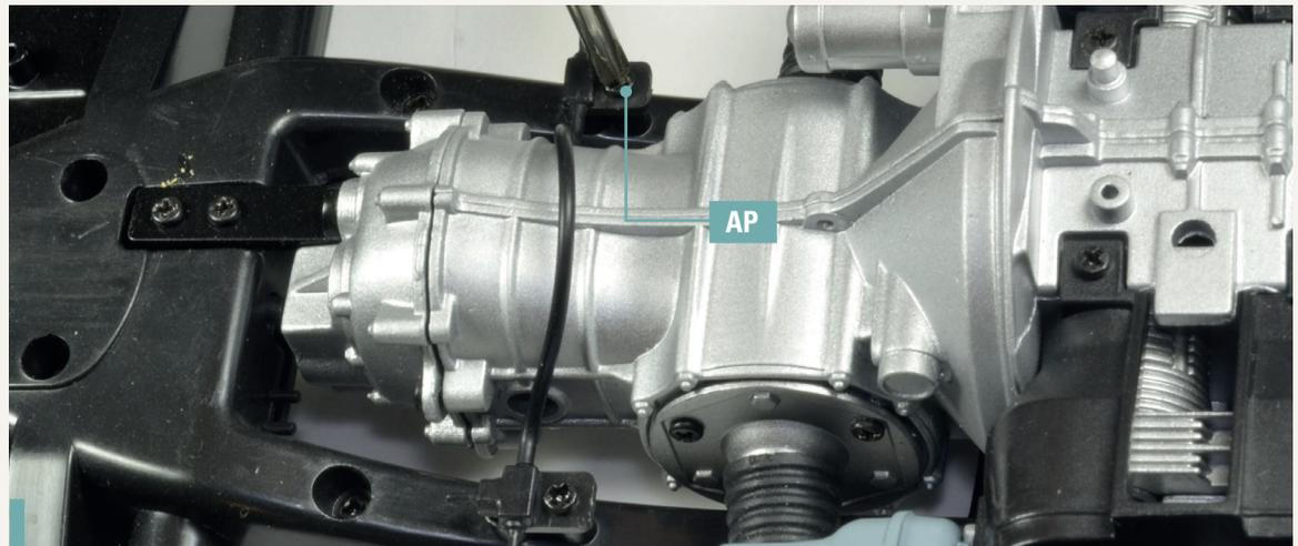
**23-5.** Montieren Sie den Anschluss auf der rechten Seite des Fahrgestell-Mittelträgers und befestigen Sie die Komponenten mit einer Schraube AP.
