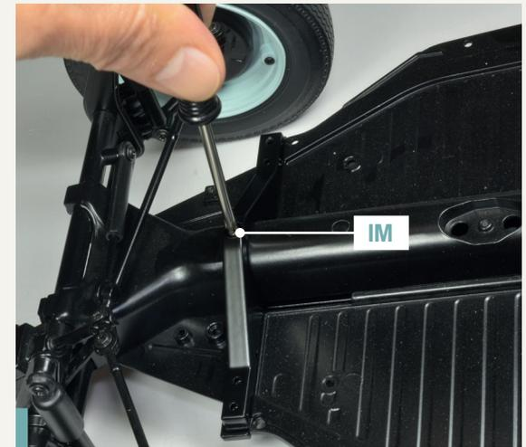
**23-7.** Vergewissern Sie sich, dass Sie die Bauteile richtig ausgerichtet haben, und beginnen Sie mit der Befestigung, indem Sie eine Schraube IM in das mittlere Loch einführen. Ziehen Sie sie nicht ganz fest.
