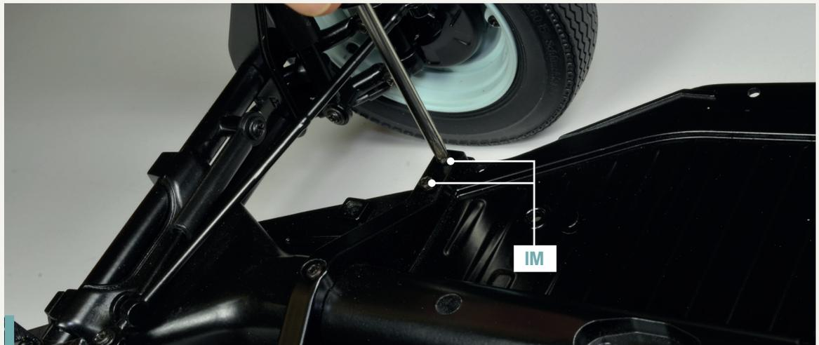
**23-9.** Setzen Sie abschließend zwei Schrauben IM in die Löcher auf der rechten Seite der Baugruppe ein. Ziehen Sie anschließend alle Schrauben an, um den Querträger am Fahrgestell zu befestigen.
