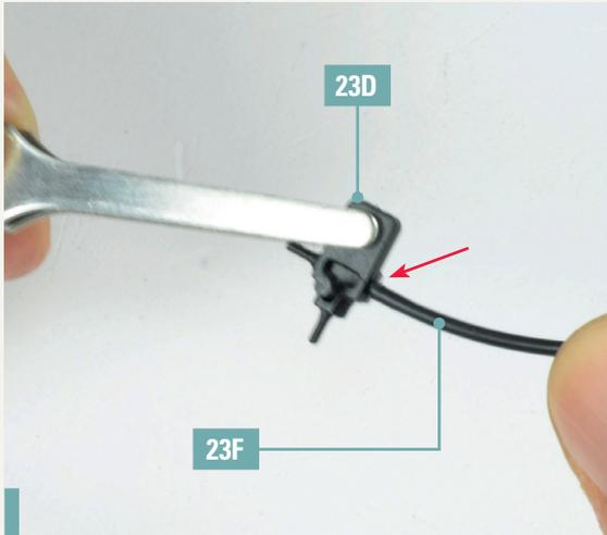
**23-1.** Richten Sie den Anschluss 23D genau wie in der Abbildung gezeigt aus und bringen Sie die Bremskreisleitung 23F an der durch den Pfeil in der Abbildung gekennzeichneten Düse an.
