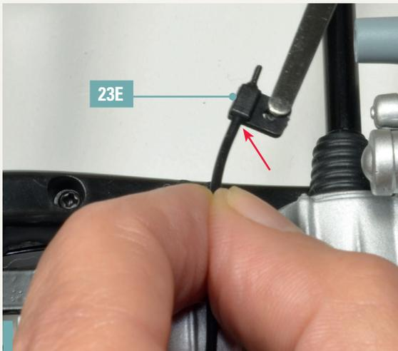
**23-4.** Schieben Sie das freie Ende der Bremskreisleitung über die Tülle des Anschlusses 23E, die mit einem Pfeil in der Abbildung gekennzeichnet ist. Richten Sie die Teile genau wie abgebildet aus.
