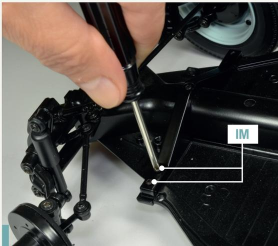
**23-8.** Setzen Sie die Befestigung fort, indem Sie zwei Schrauben IM in die Löcher auf der linken Seite der Baugruppe einsetzen. Ziehen Sie sie nicht ganz fest.
