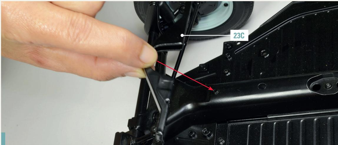
**23-6.** Legen Sie den Querträger 23C auf die Oberseite des vorderen Teils des Fahrgestells. Bestimmen Sie anhand des Fotos die korrekte Position und richten Sie das Mittelloch des Querträgers an das Loch im Fahrgestell aus, das durch den Pfeil auf dem Foto markiert ist.
