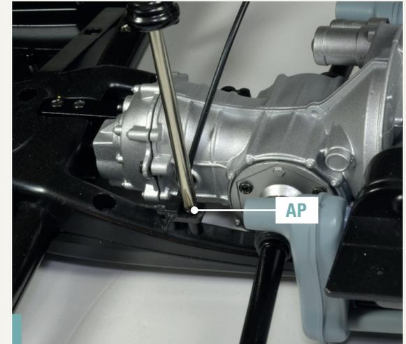
**23-3.** Überprüfen Sie, ob Sie die Teile richtig ausgerichtet haben und befestigen Sie den Anschluss mit einer Schraube AP am Fahrgestell. Die Bremskreisleitung muss über das Getriebegehäuse geführt werden.
