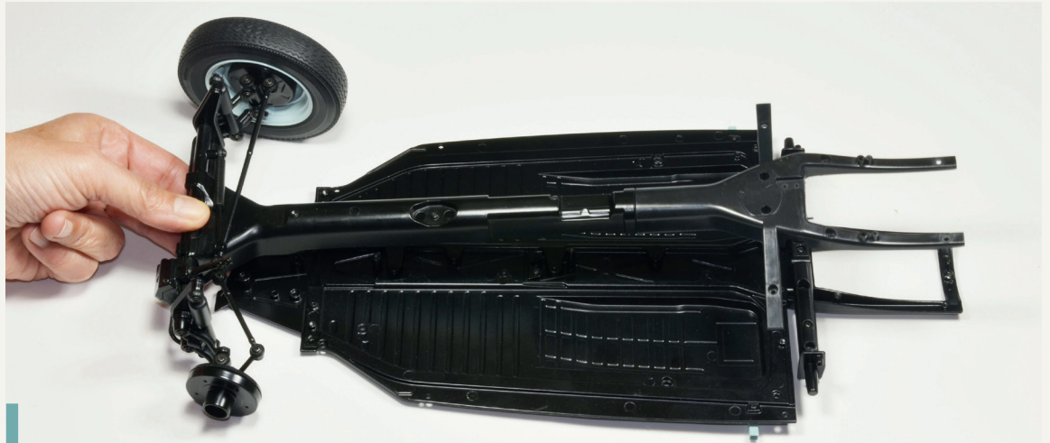
18-7. Montieren Sie die Vorderachse und das Zentralrohr auf das Bodenblech Ihres Modells. Richten Sie die Teile wie auf dem Foto gezeigt aus. Drücken Sie die Baugruppe, die aus dem Zentralrohr und dem hinteren Teil des Fahrgestell-Mittelträgers (I) besteht, nach unten.
