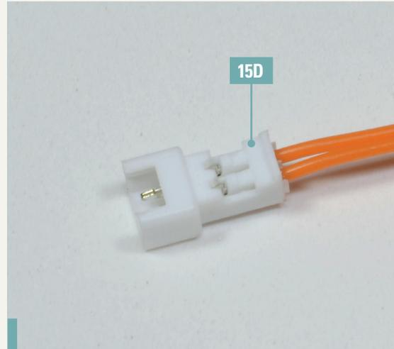
**15-2.** Das Segment B des Kabelbaums 5 15D verfügt an einem Ende über eine Buchse.
