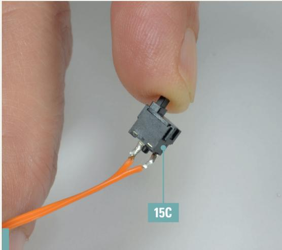
**15-1.** Das Segment A des Kabelbaums 5 15C hat an einem Ende einen Schalter. Versuchen Sie ihn mit dem Finger zu bedienen, um zu überprüfen, ob er richtig funktioniert.
