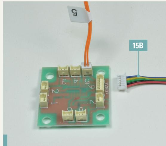
**15-5.** Die Leiterplatte 15B verfügt über einen Kabelbaum, der mit einem fünfpoligen Stecker endet. Dieser gehört in die Buchse „6“ der Platine.
