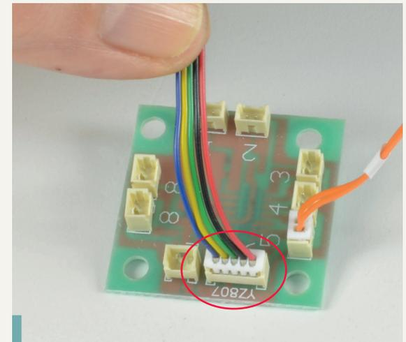
**15-6.** Führen Sie den Stecker der Leiterplatte in die Buchse „6“ der Platine ein. Richten Sie die Bauteile wie auf dem Foto gezeigt aus.
