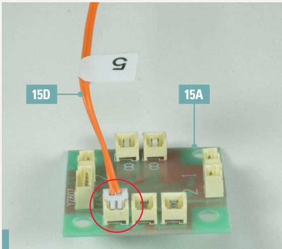
**15-4.** Stecken Sie den Stecker des Kabelbaums 15D in die Buchse „5“ der Platine 15A. Richten Sie die Teile wie auf dem Foto gezeigt aus.
