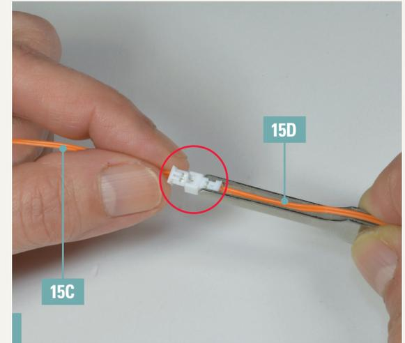
**15-3.** Verbinden Sie die beiden Segmente des Kabelbaums 5 (15C und 15D) miteinander. Stecken Sie den Stecker von 15C in die Buchse von 15D.
