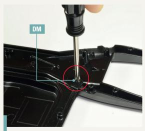
13-11. Schließen Sie die Befestigung ab, indem Sie eine weitere Schraube DM am sechsten Befestigungspunkt anziehen, der in der Abbildung durch den Kreis markiert ist. Nun können Sie alle Schrauben festziehen.
