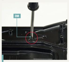
**13-10.** Führen Sie auch in den fünften Befestigungspunkt eine Schraube DM ein, ohne sie vollständig anzuziehen.
