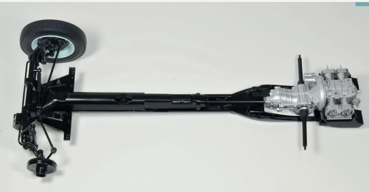
**12-5.** Um eine Vorstellung von der Größe Ihres Modells zu bekommen, können Sie die Baugruppen des Motor-Getriebes und der Vorderachse provisorisch auf dem Mittelträger des Fahrgestells positionieren, indem Sie die Komponenten wie gezeigt ausrichten.
