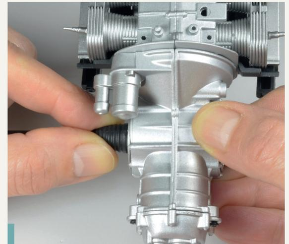
**11-13.** Schieben Sie die Gelenkschutzhülle so weit nach unten, bis sie einrastet.
