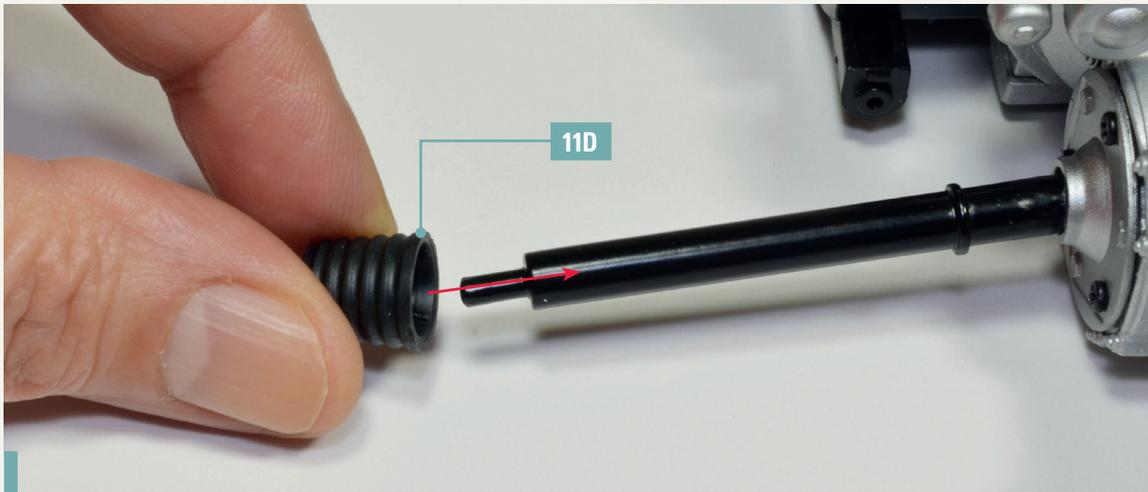
**11-12.** Schieben Sie eine der beiden Gelenkschutzhüllen 11D auf eines der Hinterachsrohre. Richten Sie die Komponenten wie abgebildet aus.
