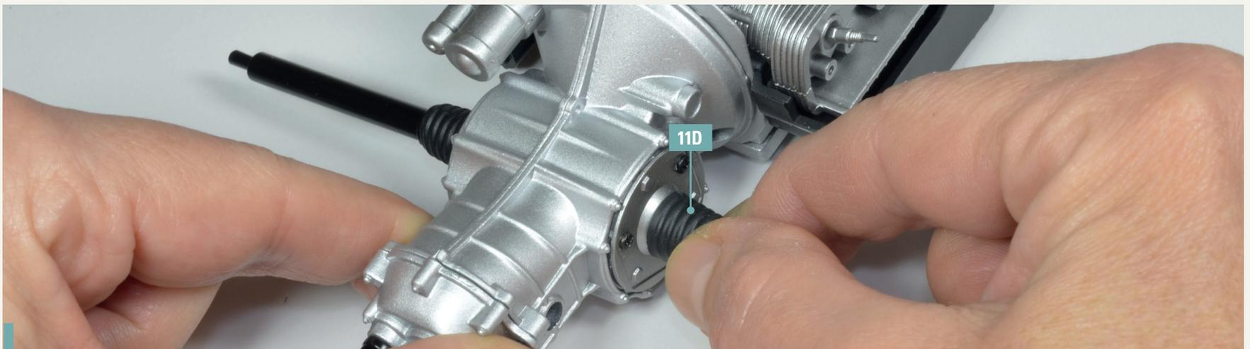
**11-14.** Führen Sie den gleichen Vorgang am anderen Hinterachsrohr durch, um auch die zweite Gelenkschutzhülle 11D zu montieren.
