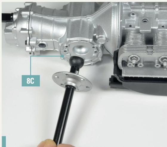
**11-10.** Bauen Sie die zweite Hinterachsrohr-Baugruppe in das linke Teil des Getriebegehäuses 8C ein. Richten Sie die Elemente wie auf dem Foto gezeigt aus.
