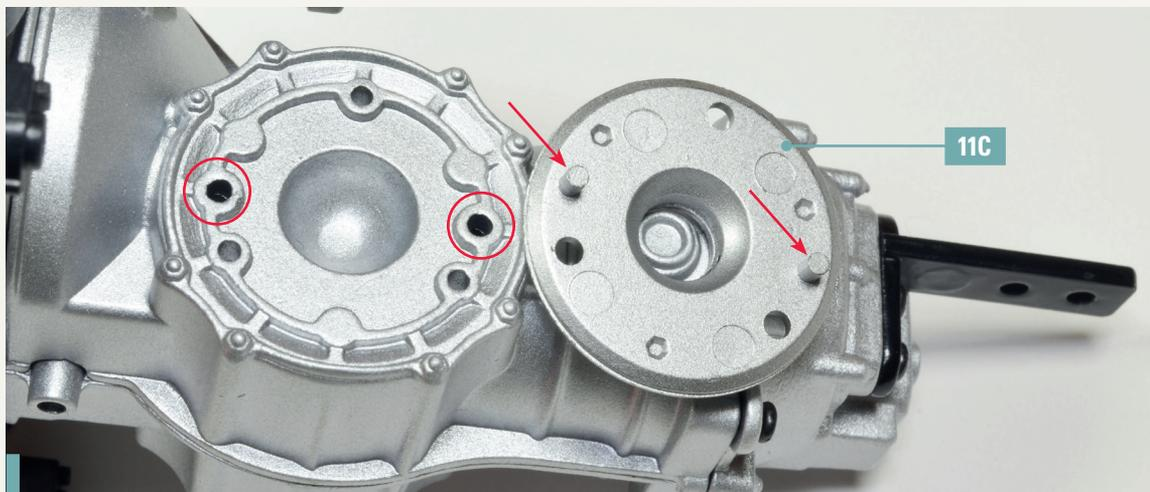
**11-1.** Schauen Sie sich das Foto genau an, um den Seitendeckel 11C in einem späteren Schritt an den Seiten des Getriebegehäuses zu befestigen. Die durch die Pfeile auf dem Foto gekennzeichneten Stifte müssen in die durch die Kreise markierten Löcher gesteckt werden.
