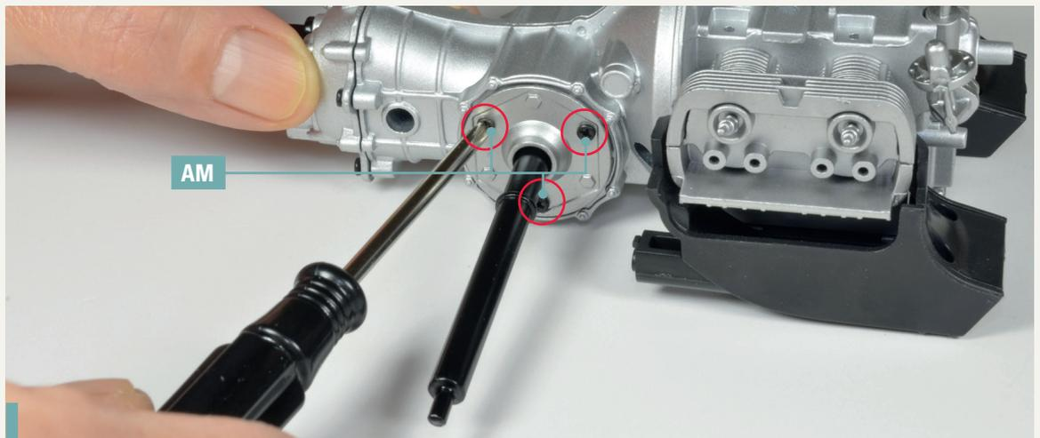
**11-11.** Befestigen Sie die Komponenten durch Anziehen von drei Schrauben AM in den auf dem Foto gezeigten Löchern.
