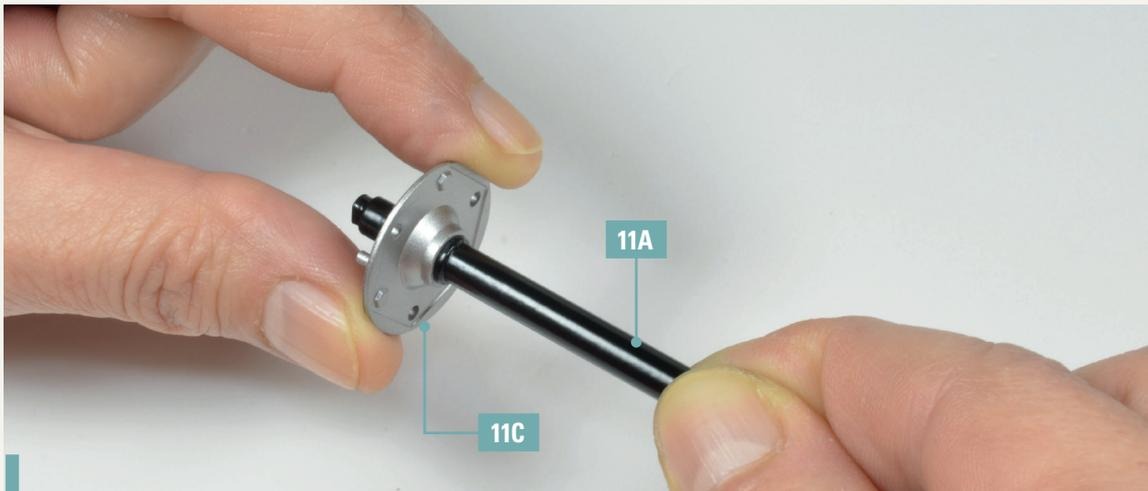
**11-7.** Stecken Sie auch das zweite Hinterachsrohr 11A durch das mittlere Loch des zweiten Seitendeckels 11C. Richten Sie die Komponenten wieder genau wie auf dem Foto gezeigt aus.
