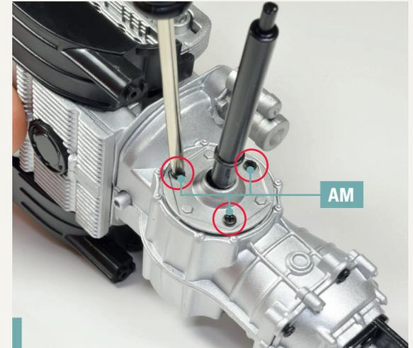
**11-6.** Ziehen Sie drei Schrauben AM in den auf dem Foto gekennzeichneten Löchern fest, um die Komponenten miteinander zu verbinden.
