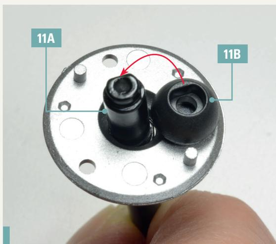
**11-3.** Montieren Sie eines der Gelenke 11B auf das Ende des Hinterachsrohrs 11A. Die Teile können nur in einer Position miteinander verbunden werden.
