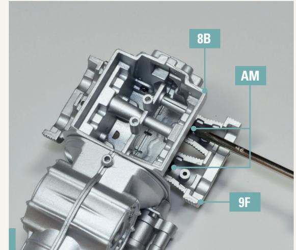
**9-3.** Wiederholen Sie diesen Bauschritt, um auch das zweite Zylinderkopfberteil 9F am rechten Teil des Motorgehäuses 8B zu befestigen. Verwenden Sie wiederum zwei Schrauben AM, um die Teile miteinander zu verbinden.
