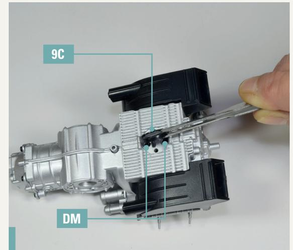
**9-9.** Ziehen Sie zwei Schrauben DM in den im vorherigen Schritt gekennzeichneten Löchern an, um die Teile zu befestigen. Danach decken Sie die Schrauben mit dem Ölablassdeckel 9C ab.
