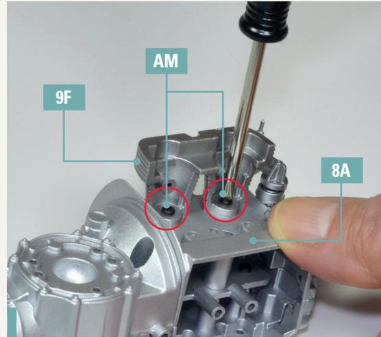
**9-2.** Montieren Sie das erste Zylinderkopfberteil 9F auf den linken Teil des Motorgehäuses 8A. Richten Sie die Komponenten wie abgebildet aus und befestigen Sie sie mit zwei Schrauben AM.
