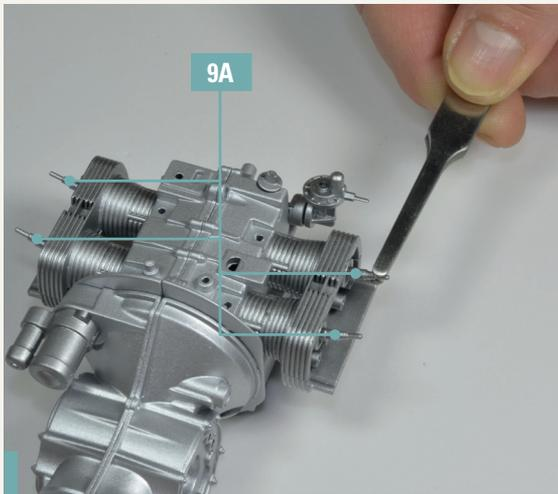
**9-6.** Montieren Sie die vier Zündkerzen 9A auf die Zylinderköpfe. Aufgrund der Form der Teile ist die Einschubrichtung vorgegeben.
