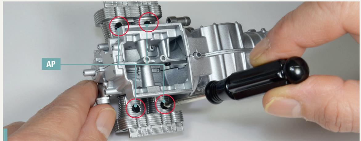
**9-5.** Befestigen Sie die Zylinderköpfe, indem Sie vier Schrauben AP in den durch die Kreise in der Abbildung gekennzeichneten Löchern anziehen.
