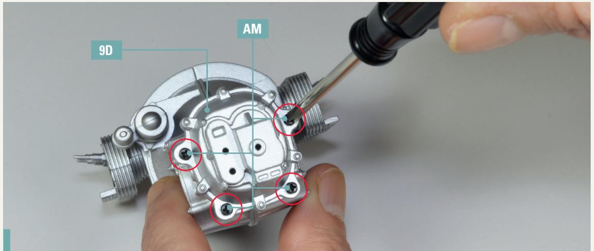
**9-7.** Befestigen Sie das Lagerschild 9D am Getriebegehäuse und richten Sie die Komponenten wie auf dem Foto gezeigt aus. Befestigen Sie sie mit vier Schrauben AM.
