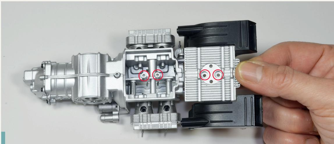
**9-8.** Verbinden Sie die Ölwanne, die Sie in Ausgabe 7 zusammengebaut haben, wie abgebildet mit dem Rest der Motorbaugruppe. Die Aussparungen, die in der Abbildung durch die roten Kreise gekennzeichnet sind, müssen übereinander ausgerichtet werden.
