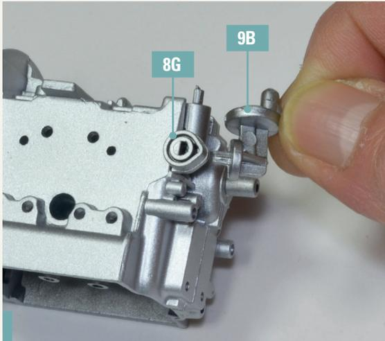
**9-1.** Stecken Sie die Kraftstoffpumpe 9B auf das Verbindungselement 8G, das Sie in der vorherigen Ausgabe am Motorgehäuse angebracht haben. Die Teile können nur in einer Richtung miteinander verbunden werden.
