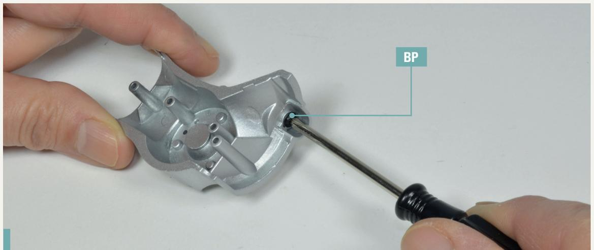
**8-4.** Befestigen Sie die Komponenten durch Anziehen einer Schraube BP in dem in der Abbildung gezeigten Loch.
