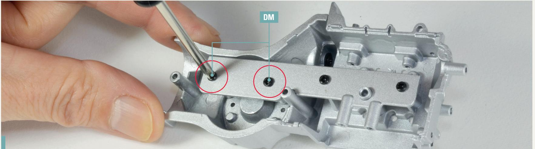
**8-7.** Ziehen Sie zwei Schrauben DM in den angegebenen Löchern an, um die Teile zu befestigen.
