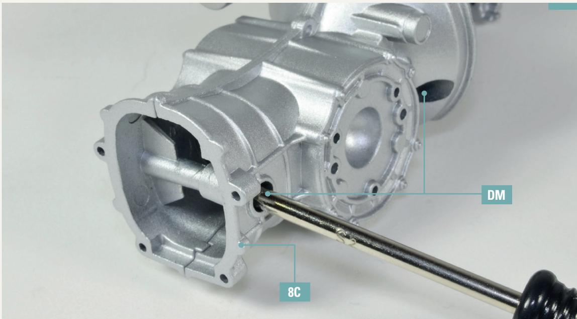
**8-8.** Verbinden Sie das linke Teil des Getriebegehäuses 8C mit seiner rechten Hälfte. Verwenden Sie zwei Schrauben DM, um die Teile zu befestigen.
