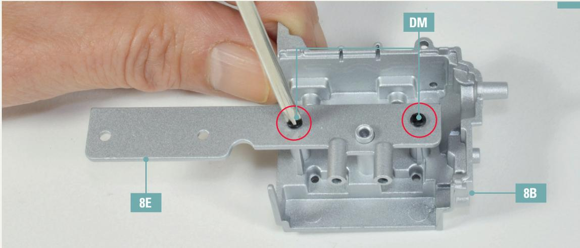
**8-5.** Setzen Sie die Querverbindung 8E auf die Innenseite des rechten Teils des Motorgehäuses 8B. Richten Sie die Bauteile wie abgebildet aus und befestigen Sie sie mit zwei Schrauben DM.
