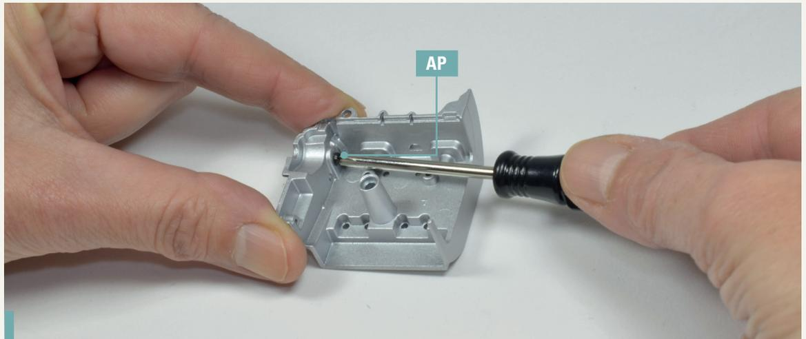
**8-2.** Befestigen Sie die Teile miteinander, indem Sie eine Schraube AP von der Innenseite des linken Teils des Motorgehäuses anziehen.
