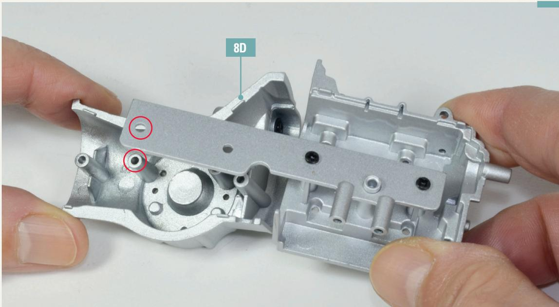
**8-6.** Befestigen Sie das rechte Teil des Getriebegehäuses 8D an der Baugruppe. Richten Sie die beiden durch rote Kreise markierten Löcher aneinander aus.
