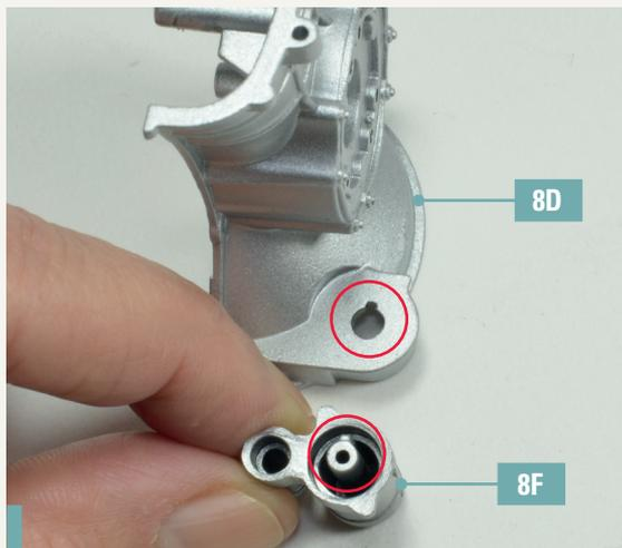
**8-3.** Montieren Sie den Anlasser 8F auf den rechten Teil des Getriebegehäuses 8D. Die Teile können nur in eine Richtung miteinander verbunden werden.
