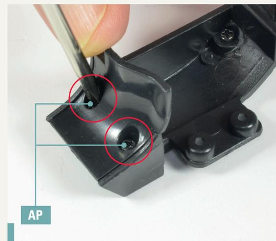
**7-4.** Ziehen Sie zwei Schrauben AP in den gekennzeichneten Löchern fest, um die beiden Teile miteinander zu verbinden.
