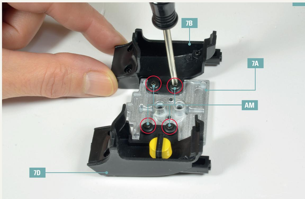
**7-8.** Verbinden Sie nun die beiden Kühlergehäuse-Baugruppen mit der Ölwanne 7A und richten Sie die Teile genau wie auf dem Foto gezeigt aus. Ziehen Sie vier Schrauben AM in den angegebenen Löchern fest, um die Baugruppe zu verbinden.
