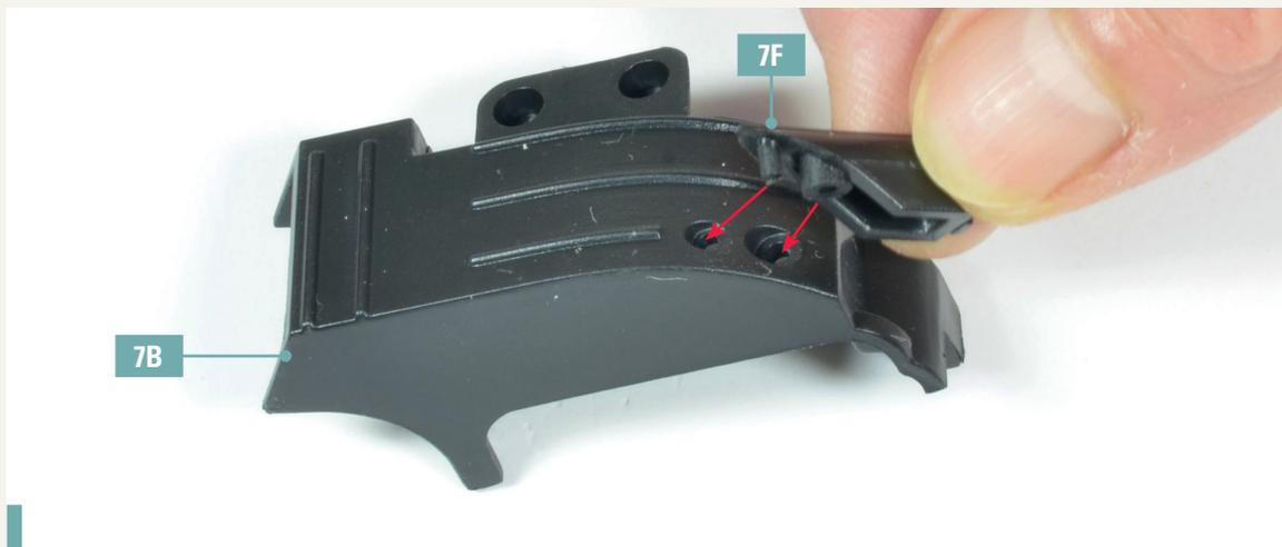
**7-1.** Stecken Sie eine Luftkanal-Verbindung 7F in die Löcher der Außenseite von Teil 1 des linken Kühlergehäuses 7B. Richten Sie die Teile wie in der Abbildung gezeigt aus.
