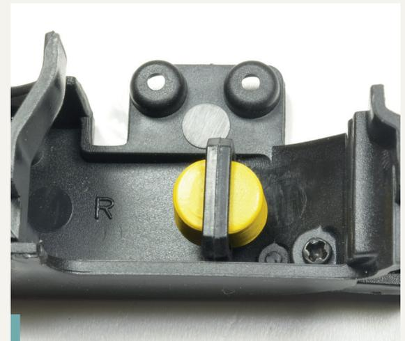
**7-7.** Montieren Sie die Thermostat-Baugruppe an die Innenseite des rechten Kühlergehäuses. Die Teile können nur in eine Richtung zusammengefügt werden.
