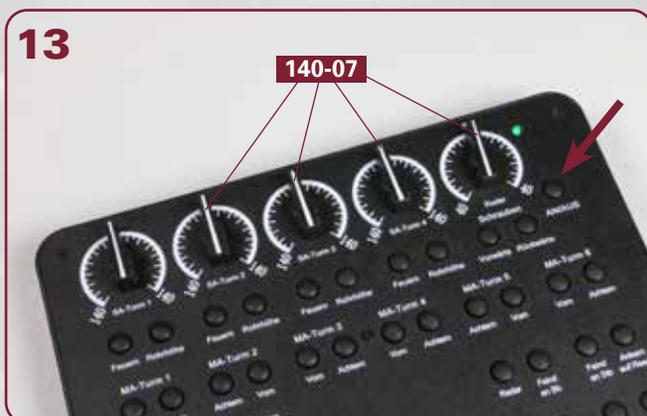
Befestigen Sie die übrigen vier Regler **140-07** an den Zapfen der Platine. Drücken Sie den Knopf AN/AUS, auf den der Pfeil weist, leuchtet die Kontrolllampe grün auf, wie abgebildet.
