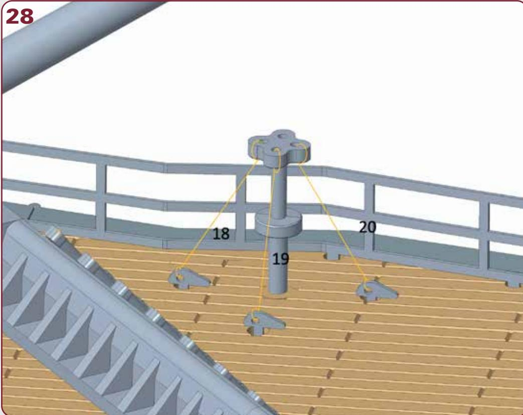
Auf der Backbordseite des Oberdecks: Die Fäden 18, 19 und 20 werden von den entsprechenden Ösen 138-11 zu den Bohrungen des Spierenbaums gespannt.
