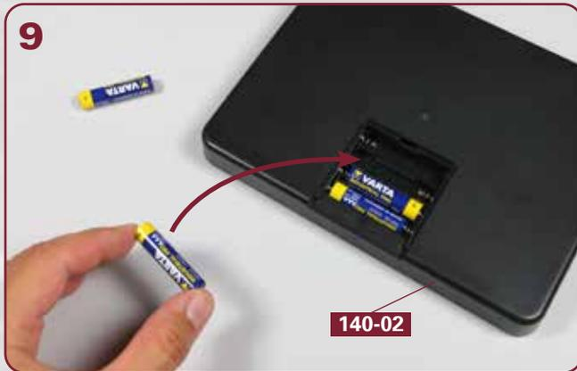
Drehen Sie den Kasten **140-02** um und setzen Sie vier Microzellen (AAA) ein, wie angedeutet.
