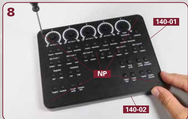
Befestigen Sie die Deckplatte **140-01** mit fünf Schrauben **NP** am Kasten **140-02**.
