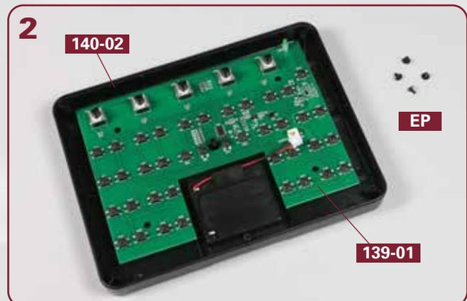
Die Platine **139-01** ist korrekt in den Kasten **140-02** eingesetzt. Legen Sie vier Schrauben **EP** bereit.
