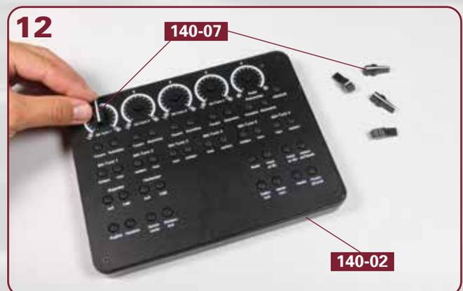
Drehen Sie den Kasten **140-02** erneut um. Trennen Sie die fünf Regler aus dem Rahmen **140-07**. Nehmen Sie den ersten Regler und drücken Sie ihn auf einem der fünf Zapfen der Platine fest.
