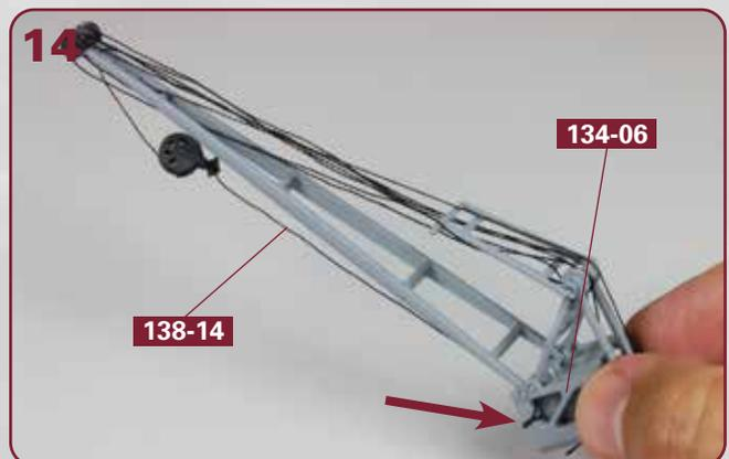
Das freie Ende vom Garnstück **138-14** wird mit einem Knoten am Krankkörper **134-06** befestigt. Der Pfeil weist auf die Stelle. Takeln Sie den zweiten Bordkran auf identische Art und Weise.
