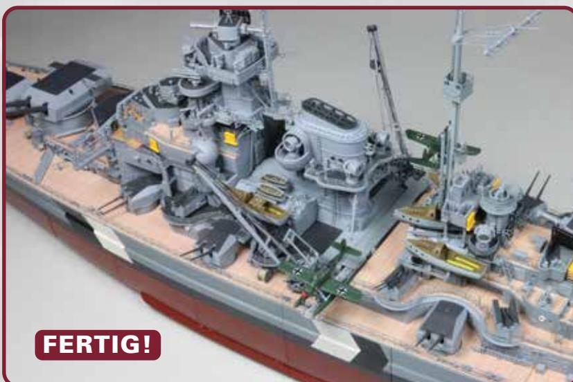
**Das Bauergebnis dieser Ausgabe:** Insgesamt 54 Ösen wurden am Rumpf, auf dem Oberdeck und an den Aufbauten befestigt. Die beiden Bordkräne wurden getakelt und auf dem Modell platziert.
