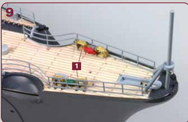
Befestigen Sie die beiden Halterungen **1** ganz vorne am Modell. Dazu werden die jeweils vier Zapfen der Halterungen in den Löchern des Oberdecks festgeklebt: rot an Backbord, grün an Steuerbord.
