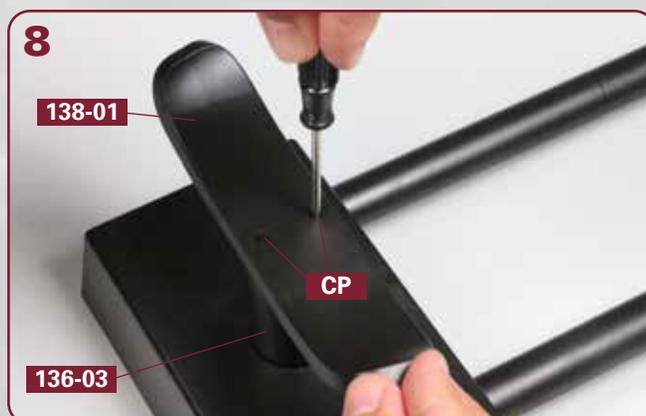
Befestigen Sie die vordere Halterung **138-01** mit den zwei Schrauben **CP** an der Trägersäule **136-03**, wie es das Foto zeigt.
