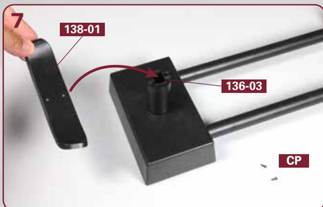
Nehmen Sie die vordere Halterung **138-01** und führen Sie sie, ausgerichtet wie abgebildet, zur vorderen Trägersäule **136-03**. Legen Sie zwei Schrauben **CP** bereit.
