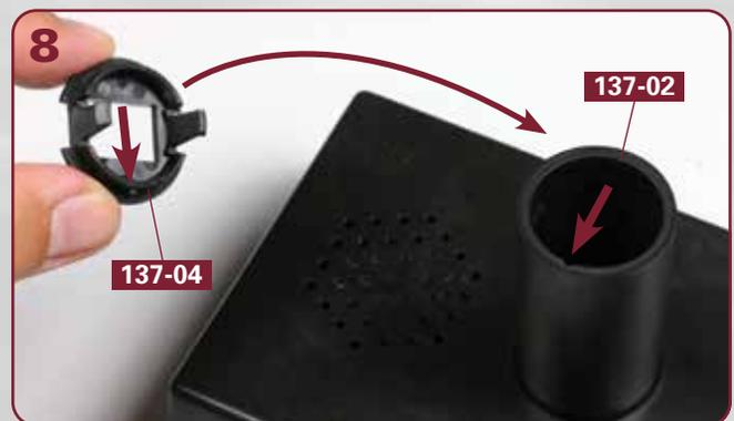
Drehen Sie den Trägerkorpus um und fügen Sie das Verbindungsstück **137-04** in die Trägersäule **137-02** ein. Die geraden Pfeile weisen auf den Zapfen bzw. die Aussparung, die zusammengehören.
