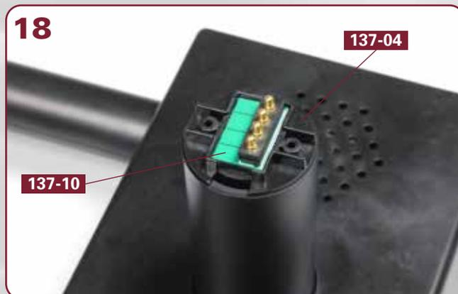
Das Foto zeigt die Endposition des Anschlusskabels **137-10** am Verbindungsstück **137-04**.
