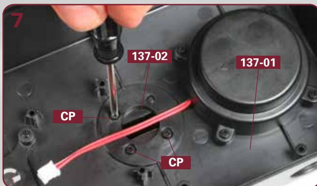
Halten Sie die Trägersäule **137-02** in Position, während Sie den Trägerkorpus **137-01** umdrehen. Fixieren Sie die beiden Teile mit drei Schrauben **CP** aneinander.
