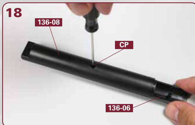
Fixieren Sie die beiden Längsträgerhälften **136-06** und **136-08** aneinander, indem Sie die Schraube **CP** eindrehen.
