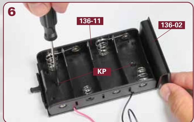
Fixieren Sie die Batteriebox **136-11** mit zwei Schrauben **KP** am Batteriefach **136-02**.
