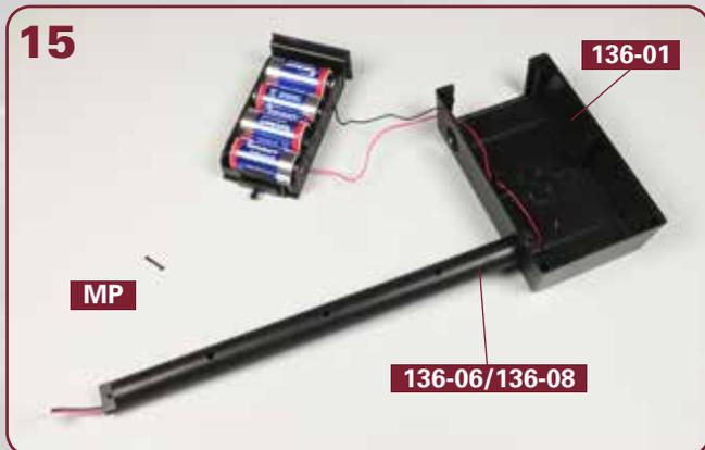
Der erste Längsträger ist komplettiert. Fügen Sie das freie Ende von **136-06/136-08** in die Öffnung des Ständerkorpus **136-01** ein, wie abgebildet. Legen Sie eine Schraube **MP** bereit.
