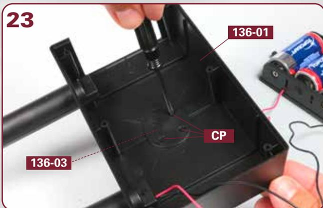
Halten Sie die Trägersäule **136-03** in Position, während Sie den Ständer erneut umdrehen. Fixieren Sie die Säule mit drei Schrauben **CP** am Ständerkorpus **136-01**, wie abgebildet.
