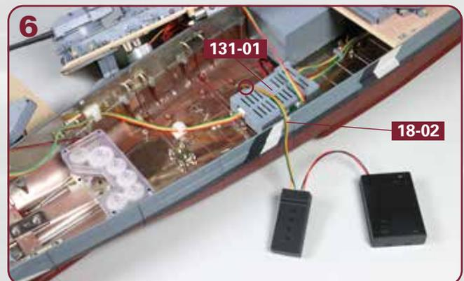
Nehmen Sie die achteren Aufbauten vom Rumpf ab und verbinden Sie das Tester-Kabel **18-02** nun mit dem (eingekreisten) Port 5 der Platine **131-01**, die mit dem Rumpfboden verschraubt ist.
