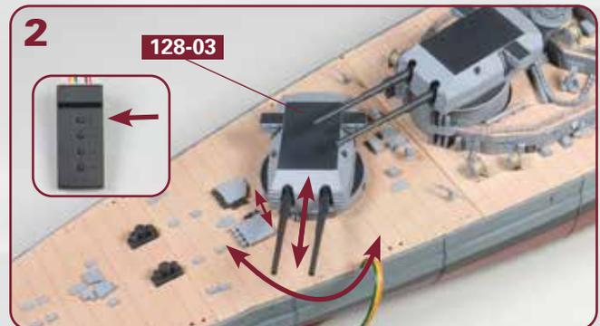
Drücken Sie nach abgeschlossener Initialisierung auf dem Tester **18-01** den Knopf „S1“ (Detailbild), läuft der Turm-Test ab. Dabei werden alle drei Turm-Funktionen simultan durchgeführt.
