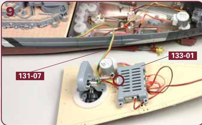
Legen Sie die achtere Oberdeckstruktur neben den Rumpf. Verbinden Sie den Stecker am hinteren Ende vom Kabel **131-07** mit dem vierpoligen, nicht nummerierten Port der Platine **133-01** (eingekreist).
