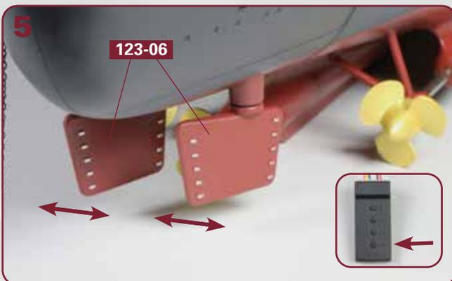
Drücken Sie auf dem Tester den Knopf „S4“, bewegen sich die beiden Ruder **123-06** hin und her. Damit ist der Test der fünften Platine beendet. Stellen Sie den Tester auf „Off“ und entfernen Sie das Tester-Kabel **18-02** von der fünften Platine.
