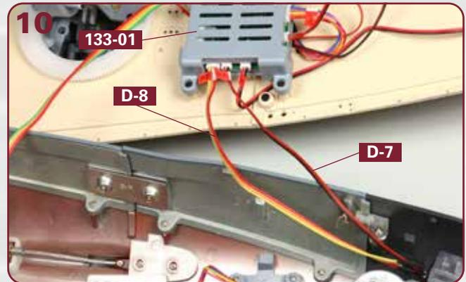
Die Kabel mit den Markierungen **D-7** und **D-8**, die beide im Heckankergetriebe enden, werden in die Ports 7 und 8 der Platine **133-01** eingefügt.
