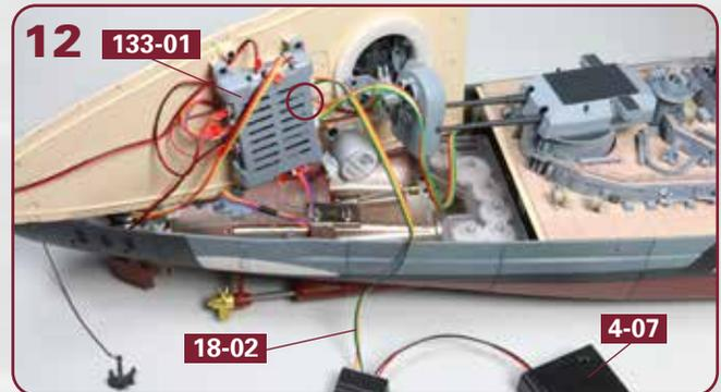
Stellen Sie den Schalter der Batteriebox **4-07** auf „Off“ und verbinden Sie den Stecker des Tester-Kabels **18-02** mit dem dreipoligen, nicht nummerierten Port der Platine **133-01** (eingekreist).
