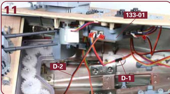
Die Kabel mit den Markierungen **D-1** und **D-2**, die im Propellergetriebe und am Rudermotor enden, gehören in die Ports 1 und 2 der Platine **133-01**.
