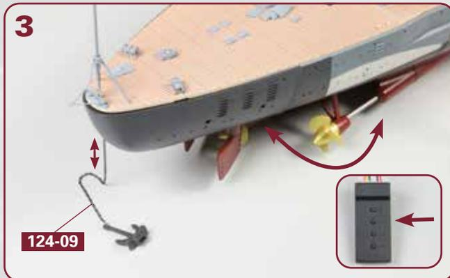
Drücken Sie auf dem Tester den Knopf „S2“, hebt und senkt sich die Heckankerkette **124-09** und die drei Propeller drehen rück- und vorwärts.
