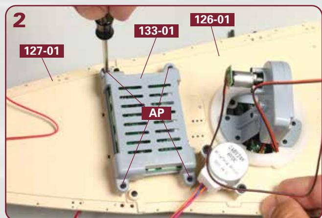
Fixieren Sie die fünfte Platine **133-01** mit vier Schrauben **AP** an den beiden Oberdeckabschnitten **126-01** und **127-01**.
