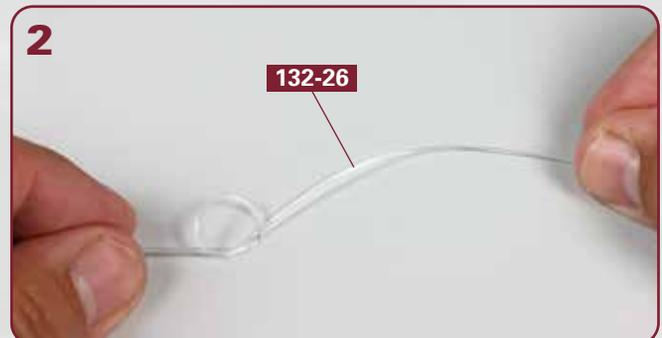
Nehmen Sie das Lichtleitkabel **132-26** und machen Sie unweit vom einen Ende einen Knoten, wie angedeutet. Ziehen Sie den Knoten stramm zu.
