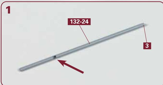
Kleben Sie Teil **3** aus dem Rahmen **132-13** an dem Ende des Heckflaggenstocks **132-24** fest, das weiter von der seitlichen Öffnung entfernt ist (Pfeil).
