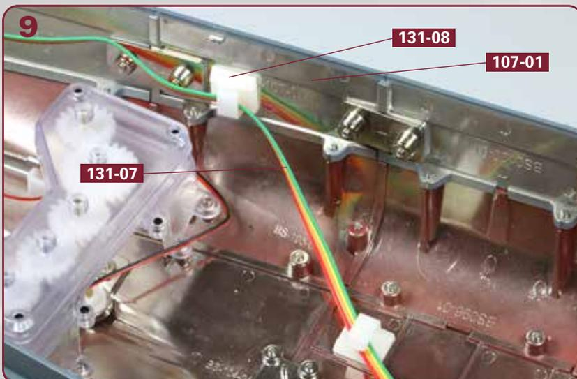
Die zweite Kabelführung **131-08** wird am linken oberen Rumpfabschnitt **107-01** angebracht. Achten Sie darauf, dass ihre Öffnung nach oben weist. Führen Sie das Kabel **131-07** durch diese Kabelführung und dann weiter in Richtung Heck.
